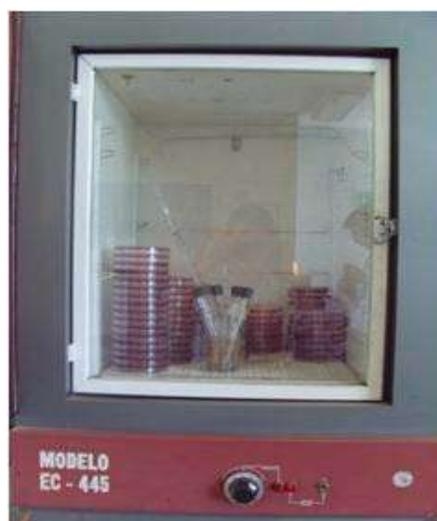
**Figura 18.** Agar Mac-Conkey empleado en el método de estriado.
