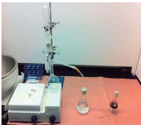
Figura 8.1.1 Dispositivo para la formación de monóxido de carbono
