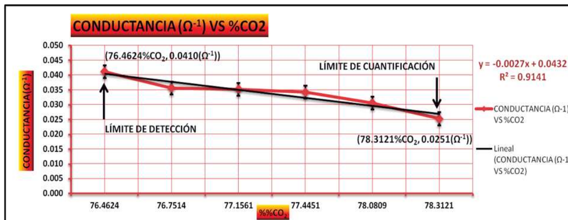
GRÁFICA 4.2.0.3 INTERVALO LINEAL DE LA CONDUCTANCIA ( \Omega^{-1} ) RESPECTO AL [%] \text{CO}_2 , PRODUCIDO POR PLANTA CARNÍVORA “ Nepenthes alata ”, EN EL METABOLISMO DE “ Tenebrio molitor ”.
