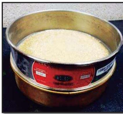
Figura 11. Tamiz con malla de 250 $\mu\text{m}$  (No. 60) del RS.
