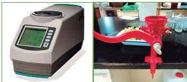
Figura 5.2.- aparatos utilizados en la obtención del polvo a) colorímetro (Color Flex); b) Molino manual
