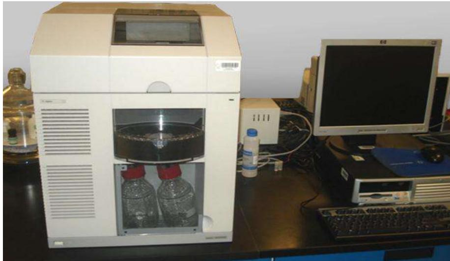
**Figura 16.** Equipo de electroforesis capilar.
