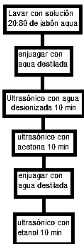
Figura 11 Metodología del lavado de vidrios
