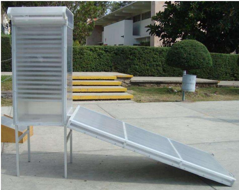
Figura 5. Secador Solar
