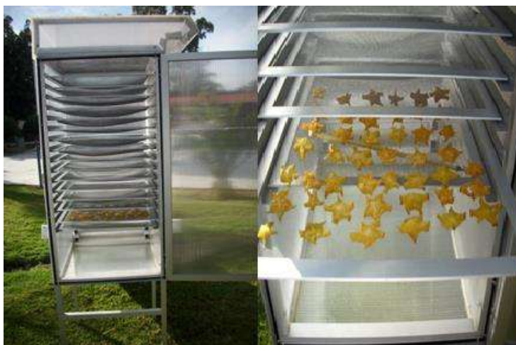
Figura 6. Proceso de deshidratación solar en la muestras de carambola
