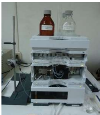
Fig. 4 Cromatógrafo de líquidos de alta resolución (HPLC) utilizado para la cuantificación de los EF.
