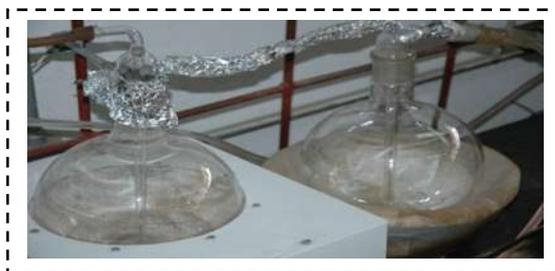
**Figura 8.** Obtención de los aceites esenciales por hidrodestilación
