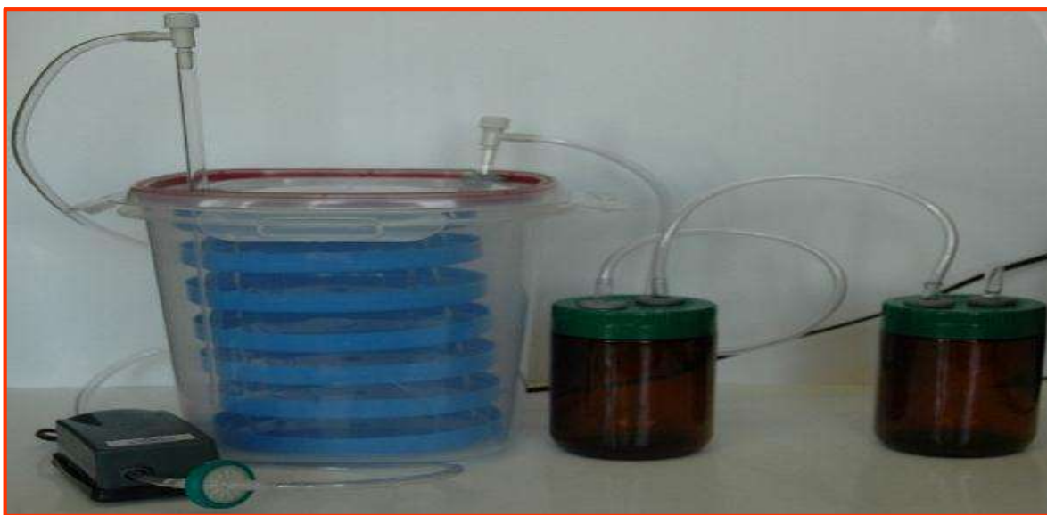
Figura 7. Diseño final de la cámara para obtención de COV's.
