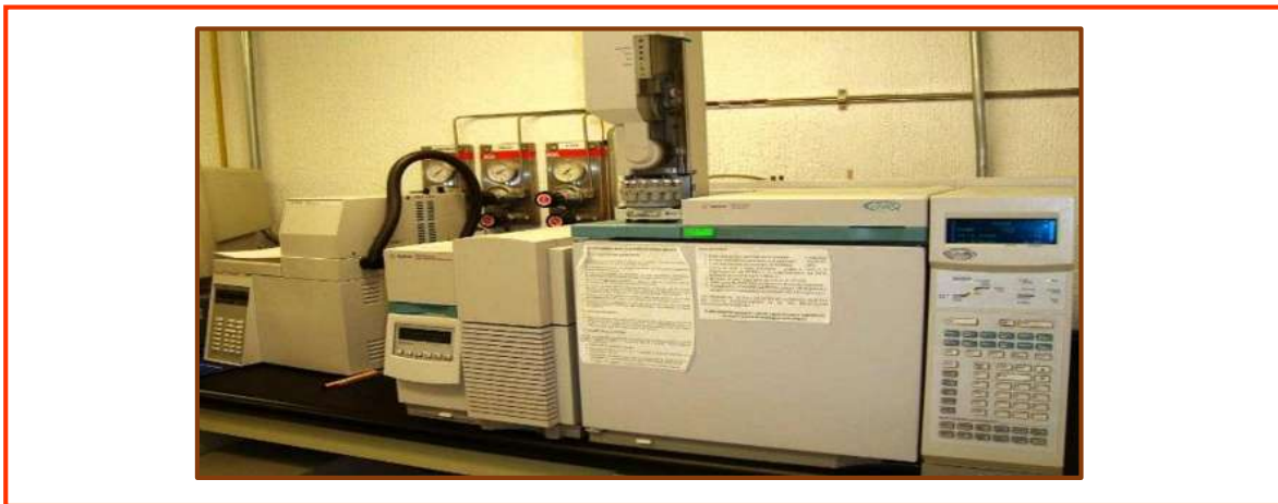
Figura 11. Cromatógrafo de gases Agilent (HP6890) equipado con un detector de masas (HP5973).
