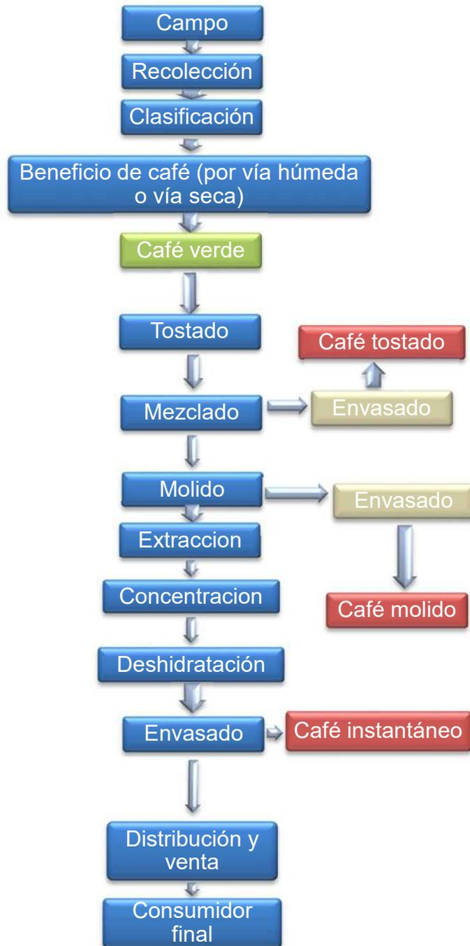
Figura 19. Diagrama de flujo de proceso tecnológico del café<sup>5</sup>
