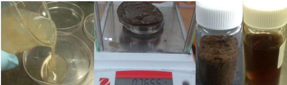
**Figura 15.** Preparación de la solución a electrohilar. De izquierda a derecha: Vaciado de la solución a cajas Petri para la evaporación del AcOH a 60°C durante 24 horas, pesado de las biopelículas secas, disolución de las películas escindidas en el solvente, solución lista para electrohilar.
