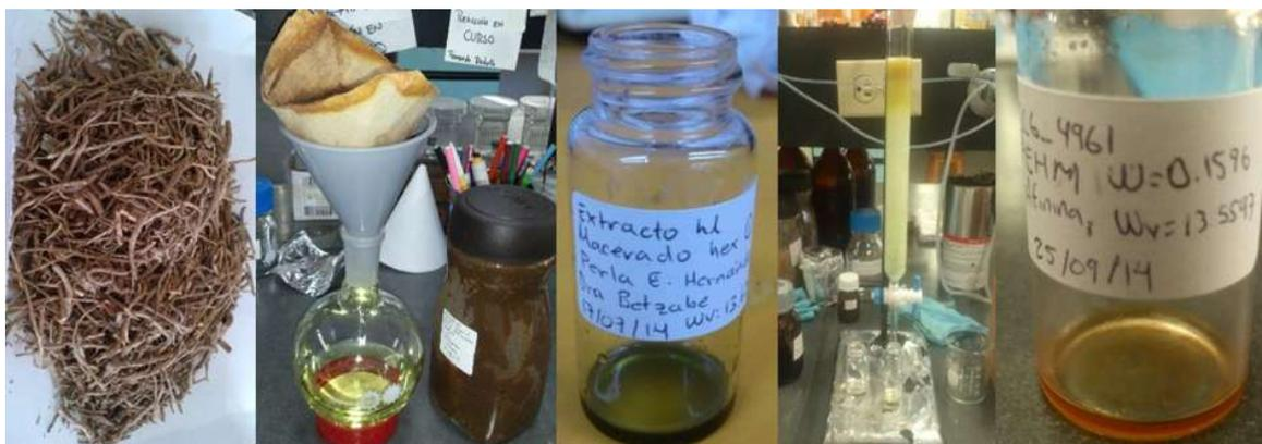
**Figura 6.** Proceso de obtención de la afinina. De izquierda a derecha: Raíces de *H. longipes*, filtración del macerado hexánico, extracto hexánico, purificación de la afinina y afinina.
