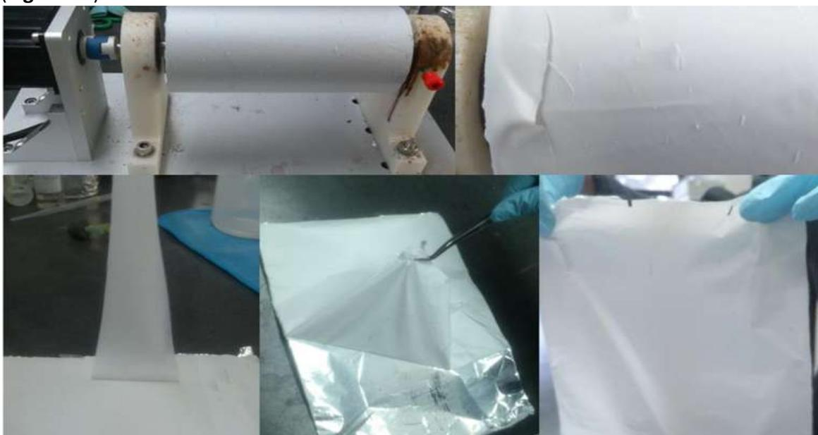
**Figura 17.** Nanofibras obtenidas. Nótese la homogeneidad, flexibilidad y grosor excelentes.
