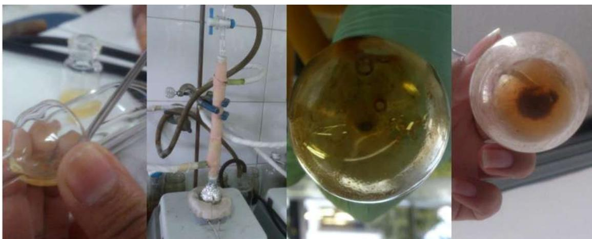
**Figura 10.** Obtención del complejo de coordinación afinina-AgNO<sub>3</sub>. De izquierda a derecha: Disolución de la afinina en acetonitrilo, reacción y equipo de reflujo en proceso para activación de la Plata, complejo de coordinación inicial (viscoso) y lavados con solventes para eliminar materia de partida.
