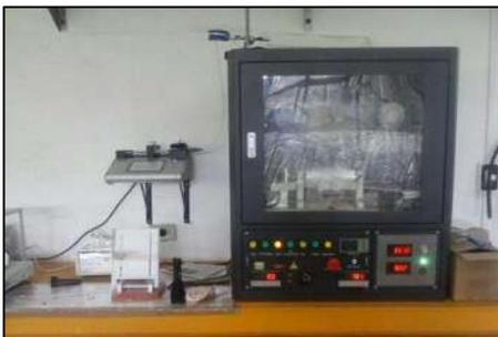
**Figura 22.-** Equipo de electrospinning para la obtención de nanofibras CTS/AgNPs y CTS/AuNPs.
