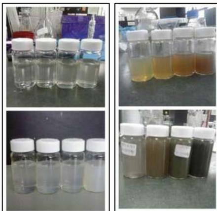
Figura 9.- Síntesis de AgNPs con radiación solar.
