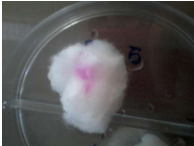
Figura 10. Detección de nitritos usando como soporte algodón. Fragmento de algodón tomado como control negativo, humedecido con solución salina.
