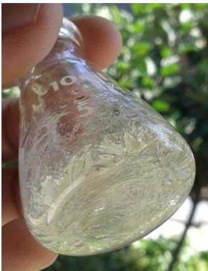
**Figura20.** Crudo de reacción empleando el reactivo de Jones.
