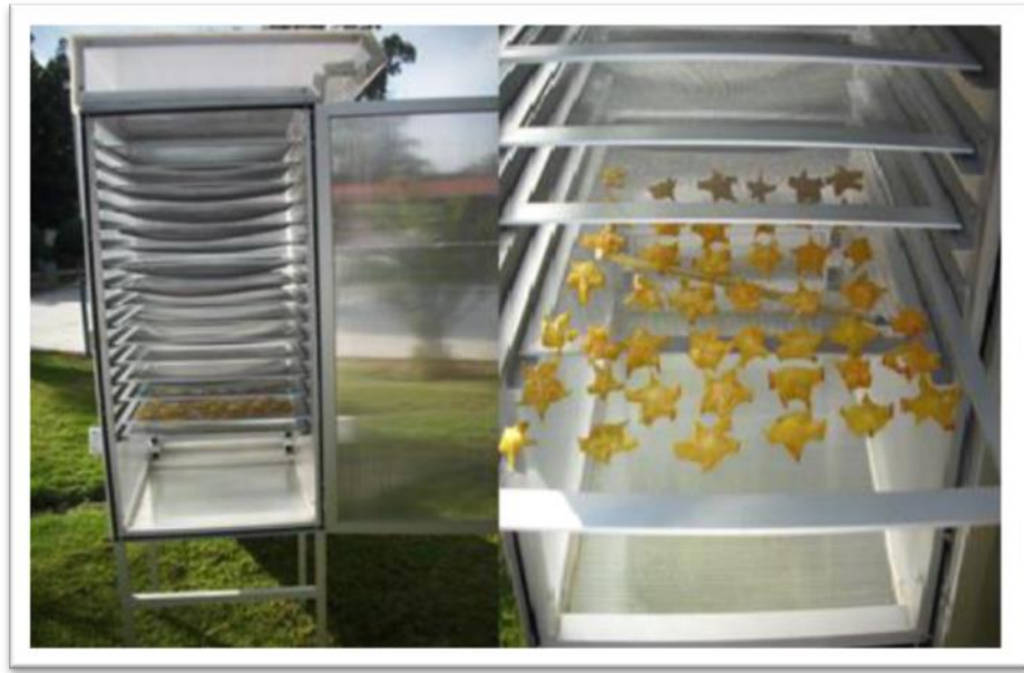
Figura 16. Proceso de deshidratación solar en las muestras de carambola
