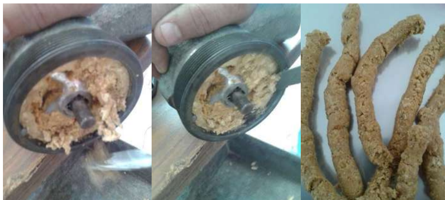
Figura 36. Obstrucción del extrusor.
