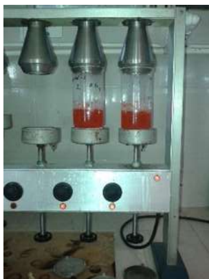
Figura 44. Determinación de fibra cruda en la fruta.
