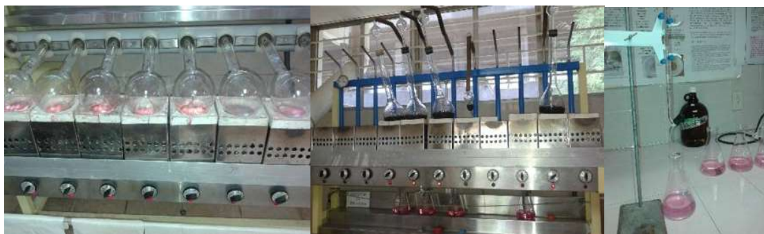
Figura 45. Determinación de Nitrógeno proteico por el método Kjeldhal.
