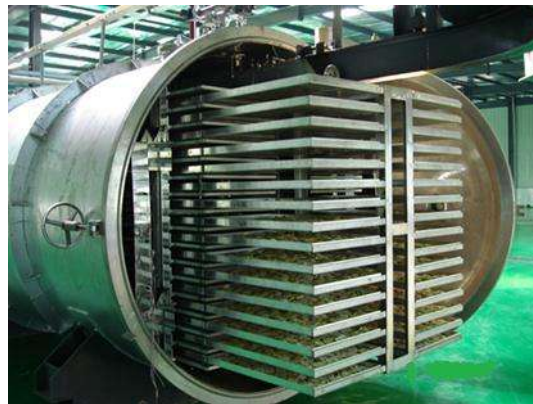
Figura 4. Liofilizador por contacto (Universidad de Granada , 2012)
