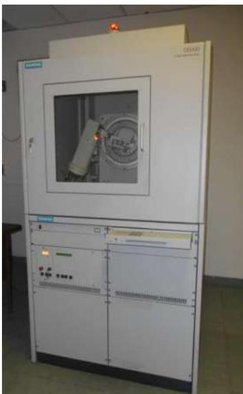
**Figura 10** Equipo de Difracción de rayos-X marca SIEMENS modelo D-500
