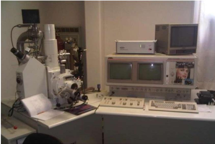
**Figura 9** Microscopio Electrónico de Barrido JSM-6400 JEOL Noran Instruments
