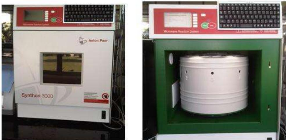
**Figura 7** Reactor de microondas marca Anton Paar modelo Synthos 3000
