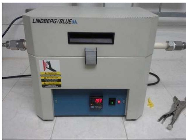
**Figura 3.7** Equipo para reducción de cristales mediante hidrogeno marca LINDBERG/BLE
