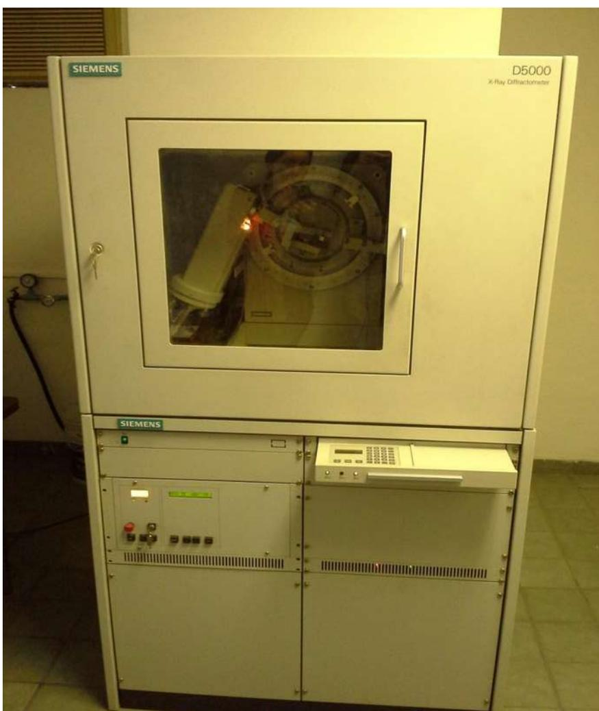
**Figura 3.9** difracción de rayos X XRD, SIEMENS D5000 X-Ray diffractometer.
