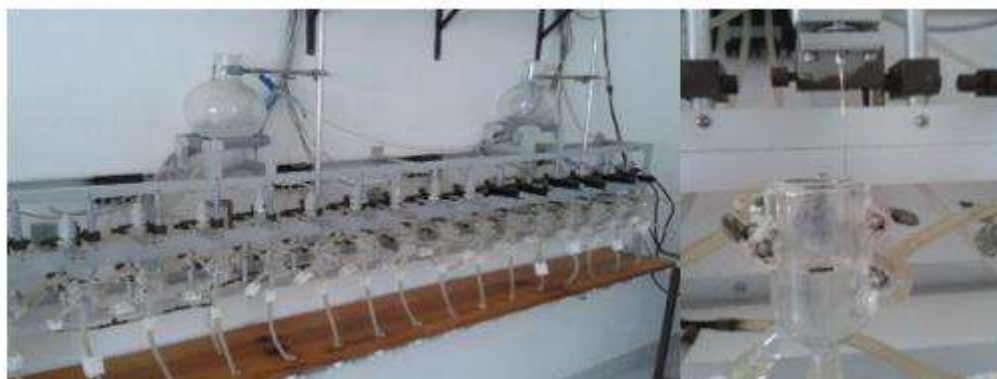
Figura 6. Equipo de órgano aislado utilizado para estudiar la respuesta contráctil.
