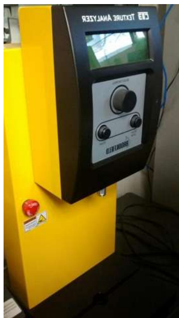
Imagen 5.- texturómetro TexturePro CT V1.7 Build 28, usado para las pruebas en las barras.
