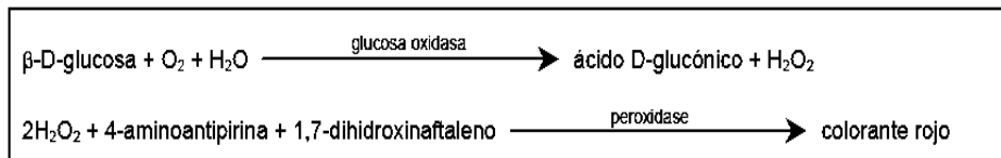
Figura 16. Secuencia de la reacción llevada a cabo para la determinación de glucosa en suero. Tomada de Products Vitros Chemistry Glu DT, 2003
