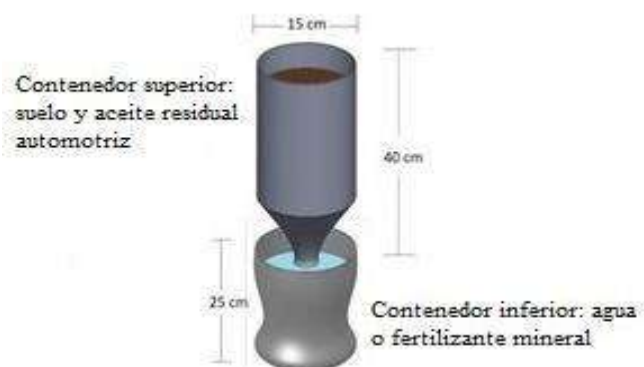
Figura 1. Jarra de Leonard para la fitorremediación de suelo contaminado con aceite residual automotriz (García-González et al., 2005).
