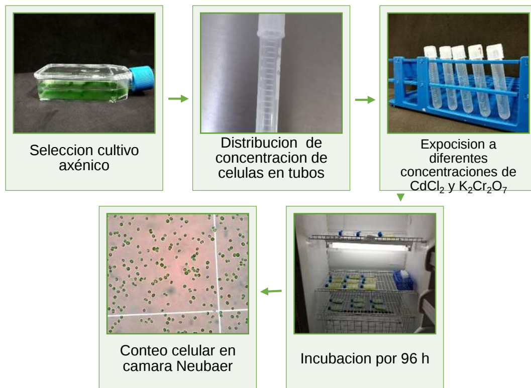
Diagrama. 2 Metodología para la determinación de las concentraciones inhibitorias de crecimiento del cloruro de cadmio y dicromato de potasio.
