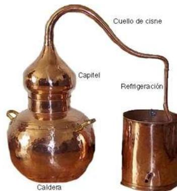
**Figura 23.** Aparato para destilación “Alambique” y partes que lo componen. (Ramírez, E. 2017).
