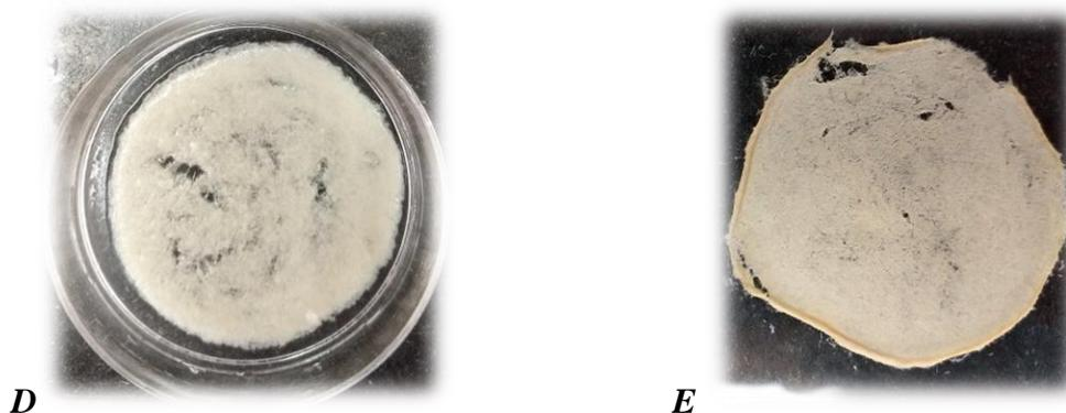
Figura 7. Metodología general del proceso de síntesis de películas porosas mediante la técnica EIPS. A) Mezcla de solución de polímeros con el DES; B) Mezcla polímero/DES en cajas Petri; C) películas después de la evaporación del disolvente acuoso; D) películas después de la extracción del DES y E) Película final después del secado.
