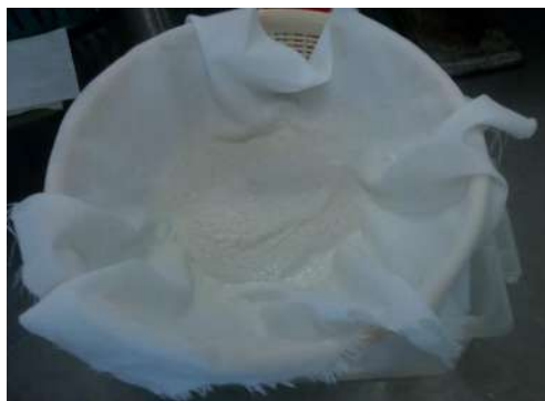
Figura 3. Filtrados del cascarón con malla de cielo, proceso realizado después de llevar a cabo la hidrólisis ácida.
