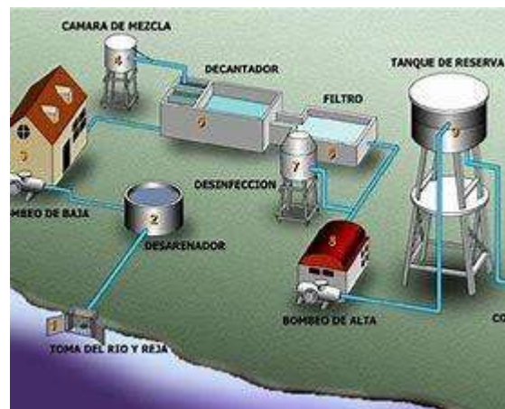
Figura 14. Planta Potabilizadora de Agua
