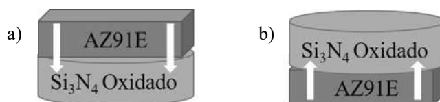
Figura 4.76. Disposición y acomodo de los materiales para el proceso de infiltración espontánea; a) gravedad y b) capilaridad.
