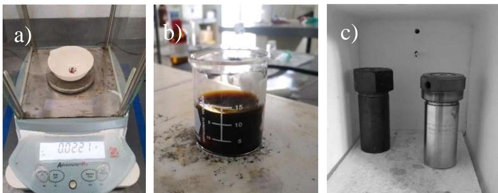
Figura 25. Mezcla de componentes y autoclaves para síntesis.
