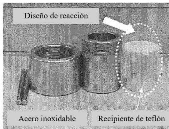
Figura 6. Partes que componen el equipo para la síntesis hidro o solvotermal [62].
