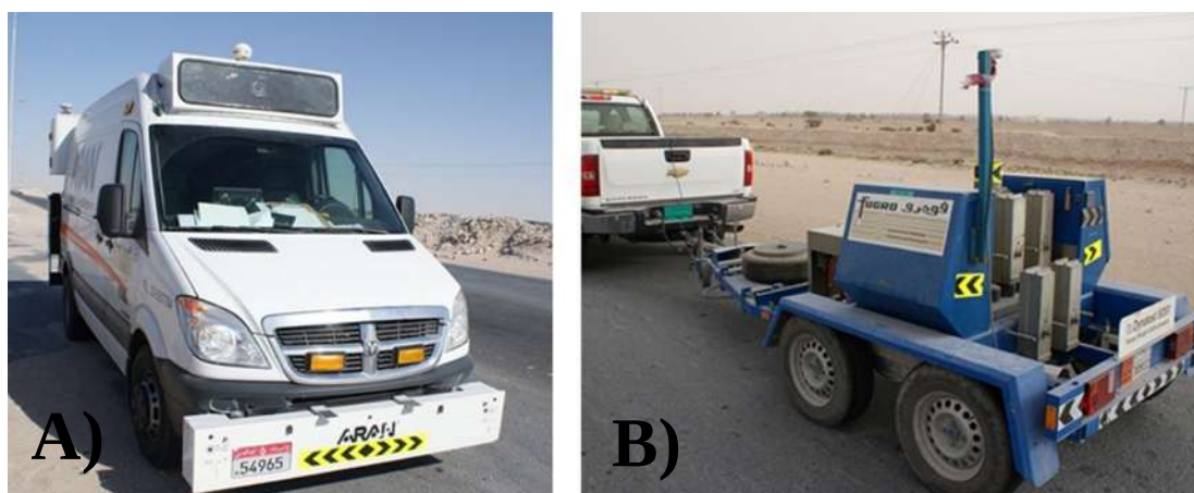
Imagen 2. A) Equipo Automatic Road Analyser (ARAN) y B) Deflectómetro de impacto (HWD) (Fuente: Tecnocarreteras)
