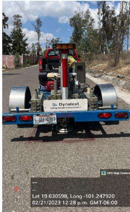
Imagen 47. Deflectómetro de impacto en zona de prueba
