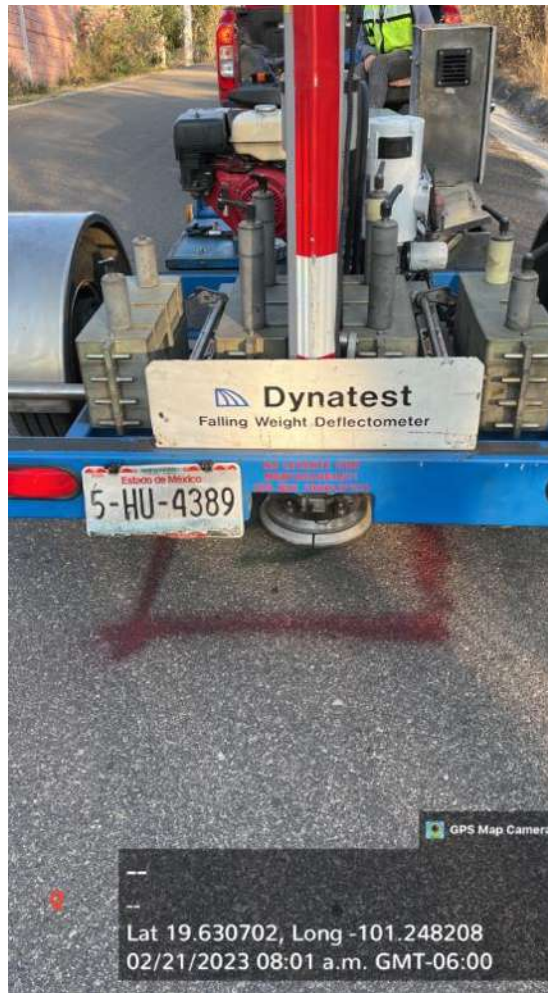
Imagen 45. Plato de carga del deflectómetro FWD apoyándose en el punto delimitado
