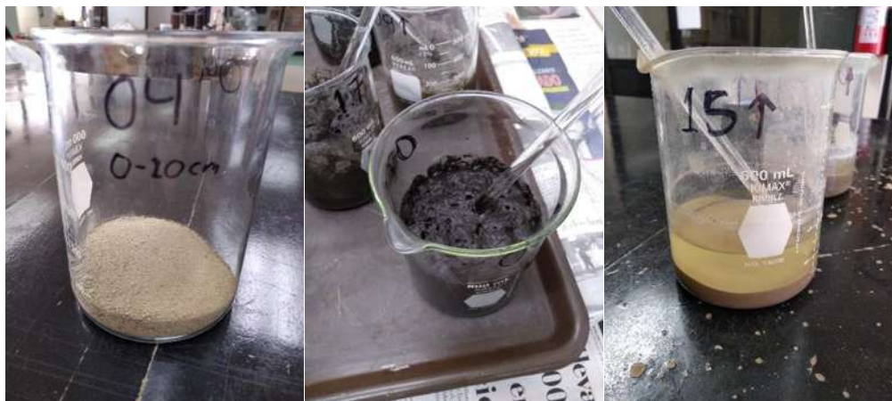
Figura 27. Procedimiento de eliminación de materia orgánica a muestras de suelo (fotos de izquierda a derecha): muestra seca tamizada a 2 mm; muestra tratada con peróxido de hidrógeno ( H_2O_2 ); muestra limpia de materia orgánica.
