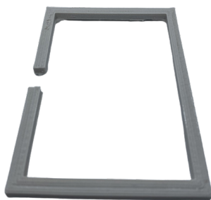
FIG.101 Modelo 3D de carcasa y carcasa impresa en PLA prototipo #2 (Autor, 2023)
