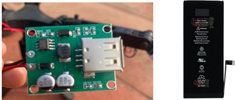
FIG.88 Módulo regulador y batería 3110 mAh. (Autor, 2023)
