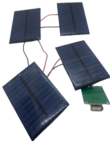
FIG.92 Paneles en paralelo con módulo regulador voltaje. (Autor, 2023)
