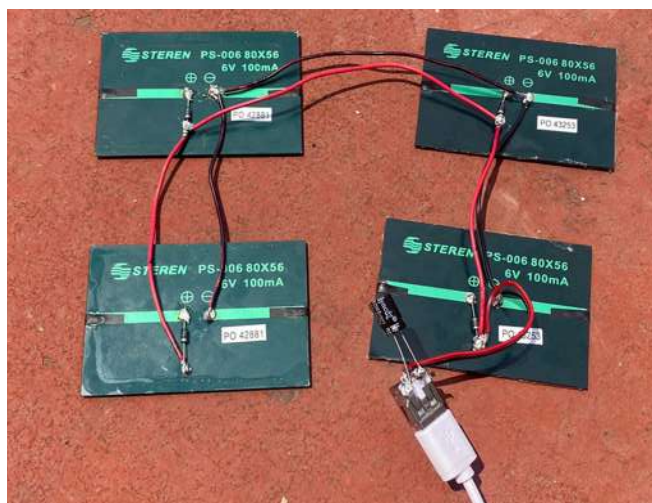
FIG.90 Paneles solares conectados en paralelo y batería de 3000 mAh (Autor, 2023)
