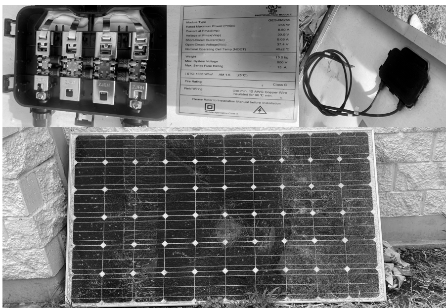
FIG.33 Caja de carga, características, conectores y panel solar. (Autor,2023)
