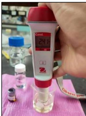
**Figura A1-7.** Determinación de la conductividad, de las solución PVA/CTS/HA.
