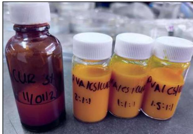
**Figura A1-2.** Soluciones PVA/CTS/CUR obtenidas a partir de la solución de curcumina 3 % p/v.
