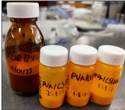
**Figura A1-3.** Soluciones PVA/CTS/CUR obtenidas a partir de la solución de curcumina 12 % p/v.
