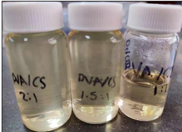
**Figura A1-1.** Soluciones PVA/CTS en proporciones volumétricas 2:1, 1.5:1 y 1:1.
