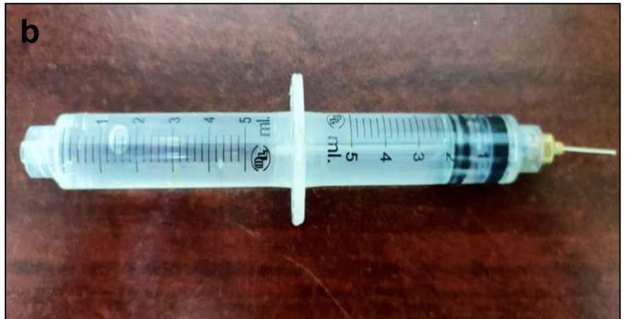
**Figura A3-2.** Diferencia de tamaño entre las jeringas utilizadas de acuerdo al dispositivo de inyección de la solución polimérica a) jeringas de 5 y 10 mL y b) pistón elaborado mediante la unión de 2 jeringas de 5 mL.
