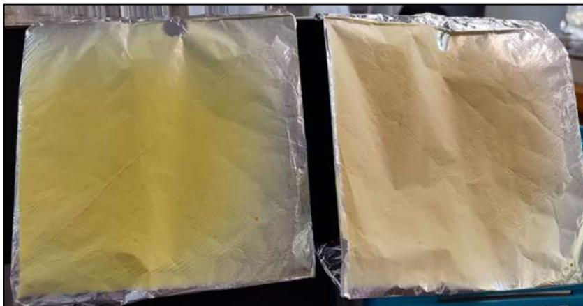
**Figura A2-1.** Colector de acero cubierto con aluminio con nanofibras PVA/CTS/CUR.
