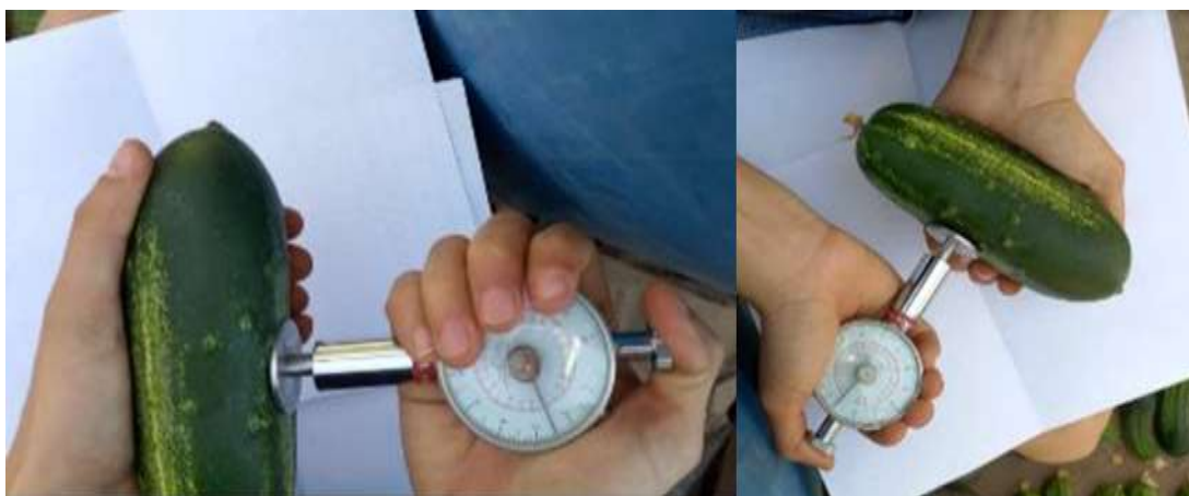
Figura 3.19. Medición de la firmeza del fruto con un penetrómetro.
