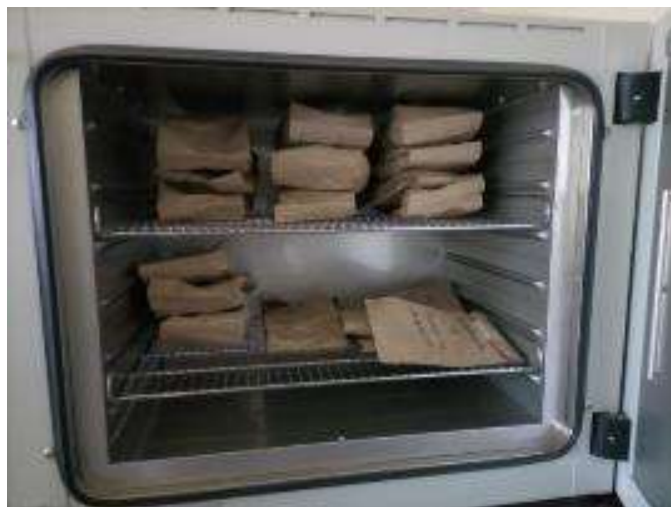
Figura 3.22. Secado de las muestras en la estufa de circulación de aire forzado.
