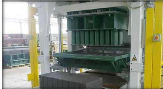
Ilustración 22 Prensa SYNCRO. Fuente: <http://www.grupoee.com/prefabricados-de-concreto-y-hormigon-syncro/>
