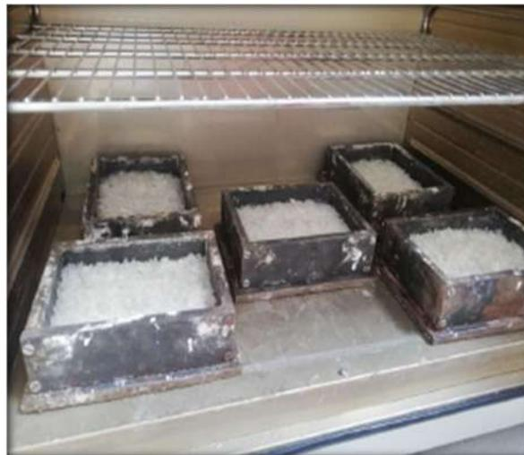
Ilustración 44 Colocación en el horno de las muestras. Fuente: "DESARROLLO DE UN NUEVO ADOQUÍN ECOLÓGICO UTILIZANDO PLÁSTICOS POST-CONSUMO Y ECOCEMENTOS"
