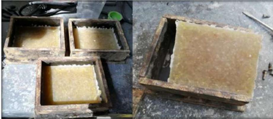
Ilustración 45 Desmolde placas. Fuente: "DESARROLLO DE UN NUEVO ADOQUÍN ECOLÓGICO UTILIZANDO PLÁSTICOS POST-CONSUMO Y ECOCEMENTOS"
