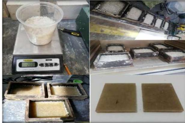
Ilustración 34 Fotos ilustrativas del proceso artesanal de la placa. Fuente: "DESARROLLO DE UN NUEVO ADOQUÍN ECOLÓGICO UTILIZANDO PLÁSTICOS POST-CONSUMO Y ECOCEMENTOS"
