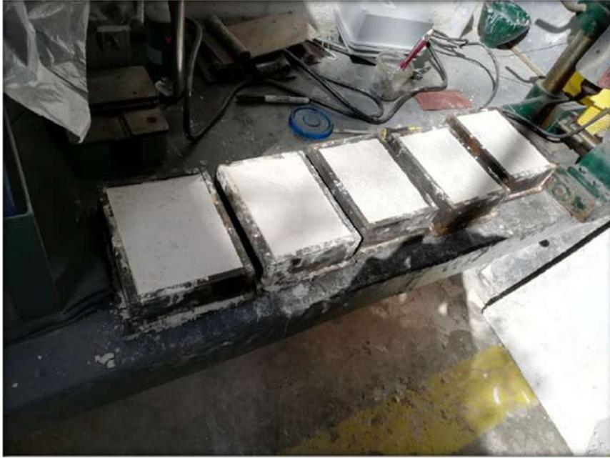
Ilustración 51 Colado y fraguado de los elementos a 24 horas. Fuente: "DESARROLLO DE UN NUEVO ADOQUÍN ECOLÓGICO UTILIZANDO PLÁSTICOS POST-CONSUMO Y ECOCEMENTOS"
