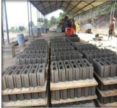
Ilustración 20 Zona de Fraguado. Fuente: <http://m.unikpavermachine.com/Content/upload/2017244706/201709081101006654588.jpg>
