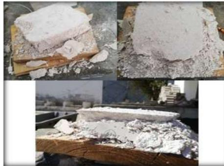
Ilustración 38 Fallo Perimetral de las muestras por carbonatación. Fuente: "DESARROLLO DE UN NUEVO ADOQUÍN ECOLÓGICO UTILIZANDO PLÁSTICOS POST-CONSUMO Y ECOCEMENTOS"
