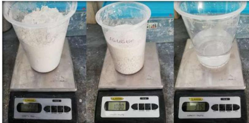
Ilustración 36 Pesaje para la elaboración de un bloque, con relación a/c=0.65. Fuente: "DESARROLLO DE UN NUEVO ADOQUÍN ECOLÓGICO UTILIZANDO PLÁSTICOS POST-CONSUMO Y ECOCEMENTOS"
