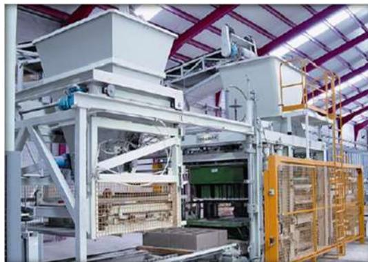
Ilustración 23 Prensa Megablock. Fuente: <http://www.grupoee.com/prefabricados-de-concreto-hormigon-megablock/>
