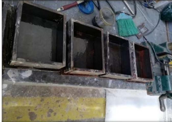
Ilustración 49 Moldes Engrasados preparados para el vertido. Fuente: "DESARROLLO DE UN NUEVO ADOQUÍN ECOLÓGICO UTILIZANDO PLÁSTICOS POST-CONSUMO Y ECOCEMENTOS"
