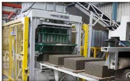
Ilustración 21 Prensa Fija. Fuente: <http://www.grupoeec.com/prefabricados-concreto-hormigon-prima-p50/>
