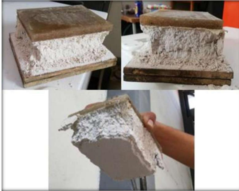
Ilustración 41 Resistencia mostrada al centro del elemento a causa de la carbonatación y las placas.
