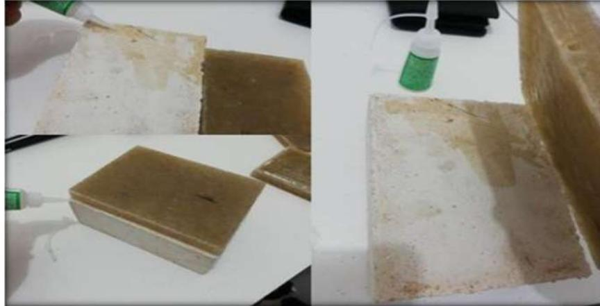
Ilustración 39 Unión del polímero y el Ecocemento mediante cianoacrilato de metilo. Fuente: "DESARROLLO DE UN NUEVO ADOQUÍN ECOLÓGICO UTILIZANDO PLÁSTICOS POST-CONSUMO Y ECOCEMENTOS".
