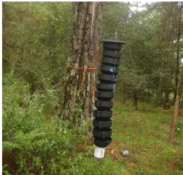
Figura 4. Trampa Lindgren de 12 embudos colgada en los bosques de la Comunidad Indígena de Nuevo San Juan Parangaricutiro.
