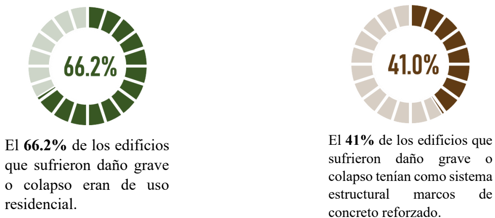
Figura IV-9 Porcentaje de edificios que sufrieron colapso y/o daños graves respecto al uso y sistema estructural para el sismo de 2017. Obtenido de (Jara, 2020)
