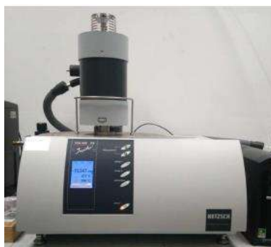
Figura 8. Equipo STA 449, F3 Júpiter.
