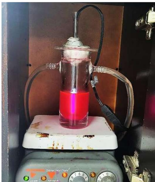
*Imagen 8. Sistema de reacción de degradación fotocatalítica de la Rodamina-B.*
