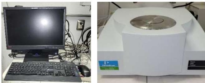
*Imagen 2. Equipo termogravimétrico, Perkin Elmer, STA 6000.*
