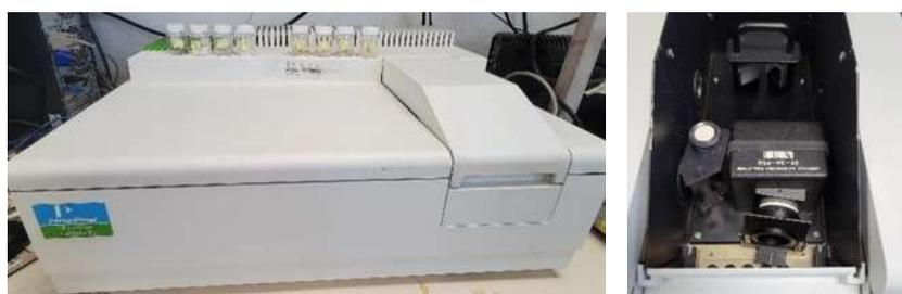
*Imagen 3. Espectrofotómetro Perkin-Elmer, Lamda 35 y esfera de integración.*
