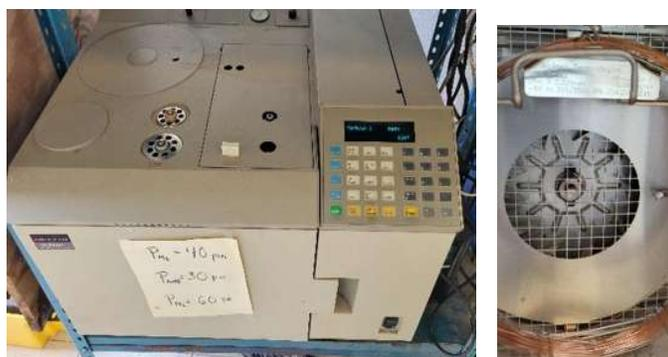
Imagen 6. Cromatógrafo de gases Perkin Elmer, AutoSystem XL y columna capilar HP-ULTRA2.
