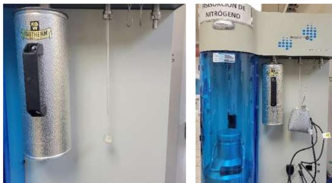
*Imagen 5. Equipo de fisisorción de N<sub>2</sub>, Quantachrome Autosorb iQ.*
