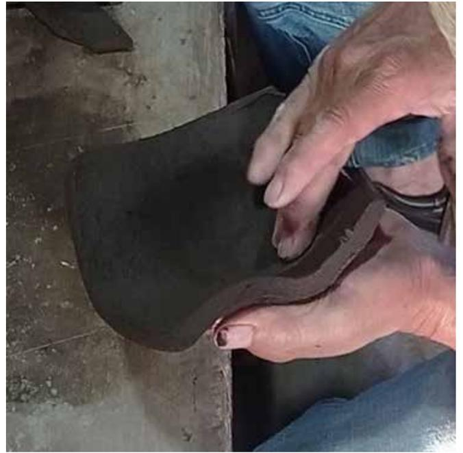
Debido a que en este caso se realizó una primera aproximación se determinó que podrían estar haciendo falta otros elementos que facilitaran el uso de los moldes, en este caso un elemento que tomara todos los componentes que crean la forma final y los mantuvieran unidos de forma confiable y segura. Pero al ser esta una etapa inicial, se improvisó una técnica en la cual el artesano sujetaba todos los módulos de yeso con una mano y les colocaba el barro con la otra para darle así la forma deseada.
