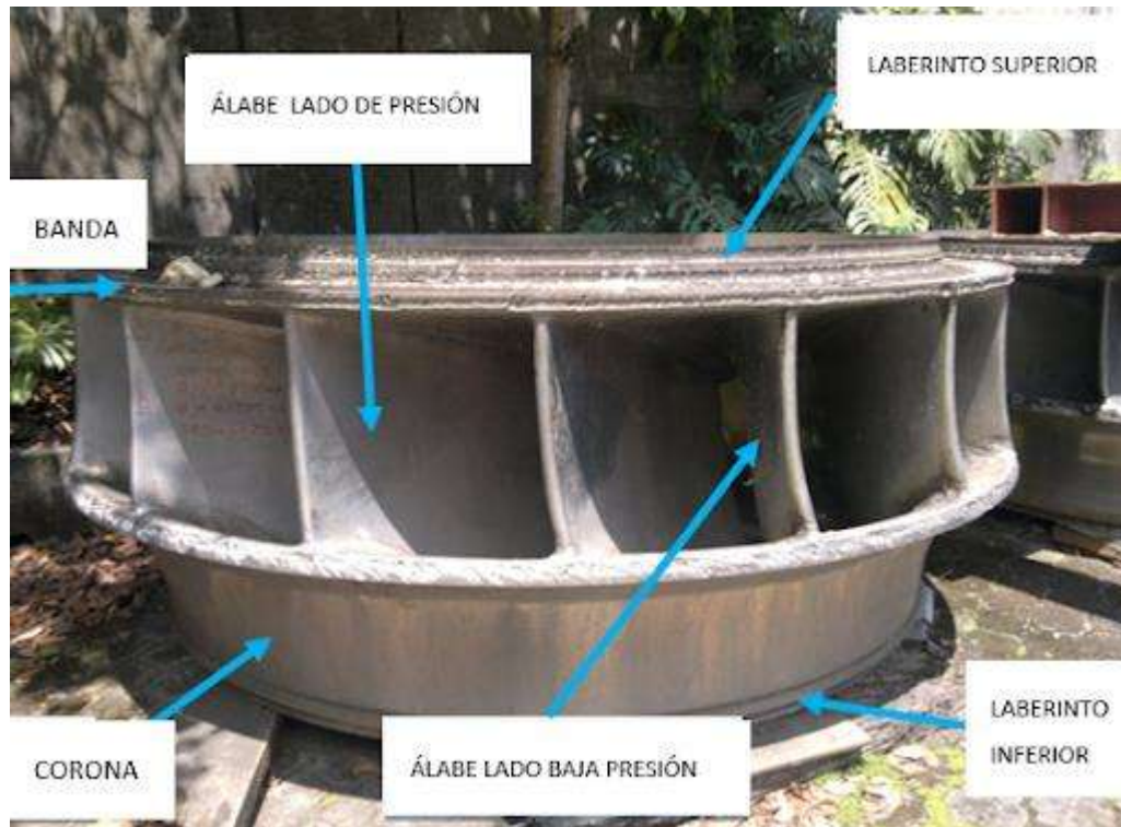
Figura. 2.5. Principales componentes del rotor de una turbina Francis [7].
