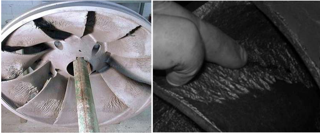
Figura. 1.1 Daños en los álabes del rodete de una turbina Francis por problemas de cavitación [1], [2].
