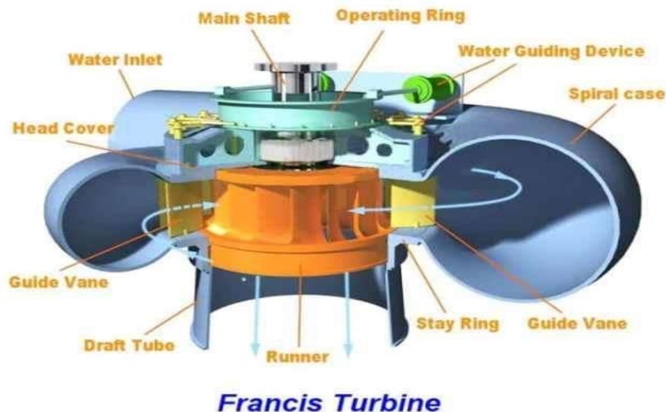
Figura. 2.4. Principales componentes de una turbina hidráulica Francis [6].
