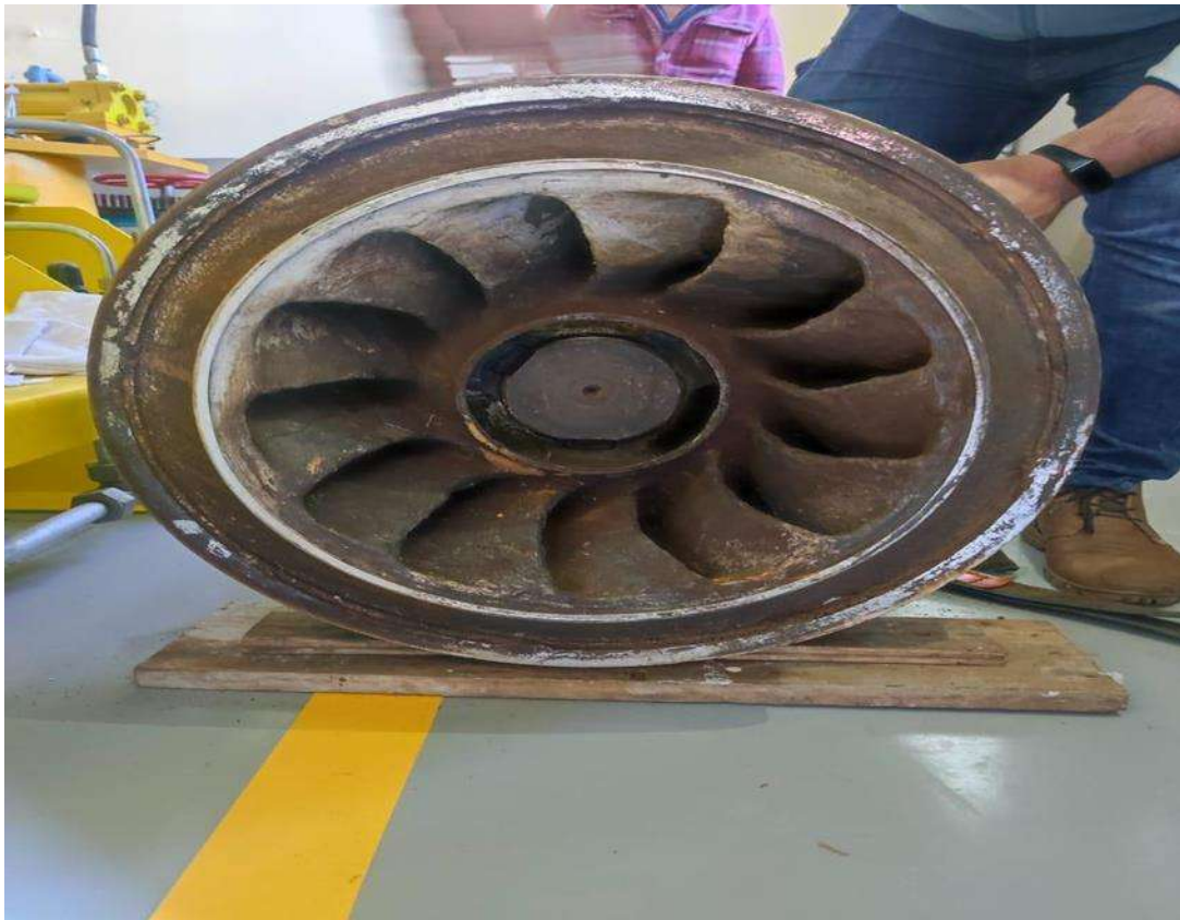
Figura. 1.2. Rodete de una turbina Francis con álabes dañados como propósito de investigación.
