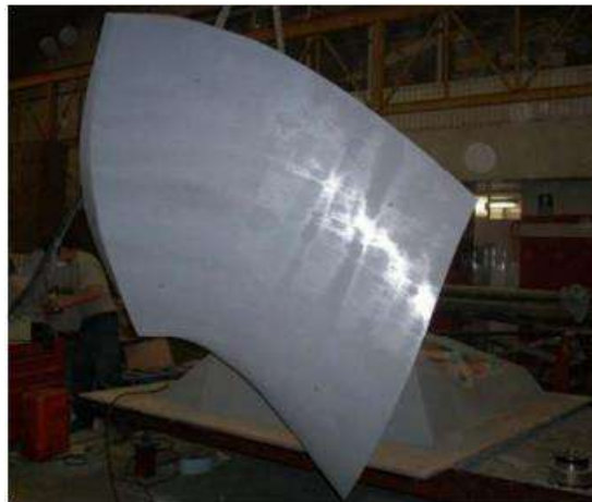
Figura 2.11. Álabes manufacturado en madera a tamaño real [11].
