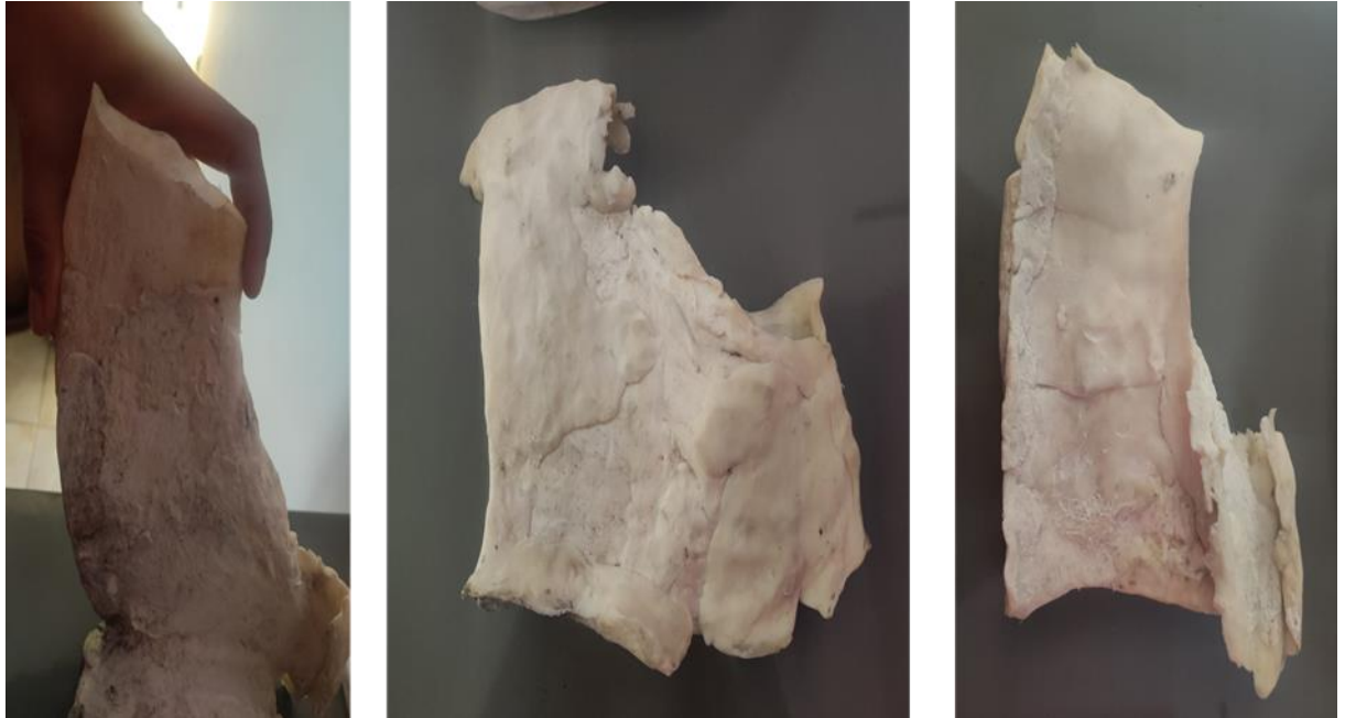
Figura.3.9. Molde del álabe obtenido con la mezcla de silicona y Maizena.
