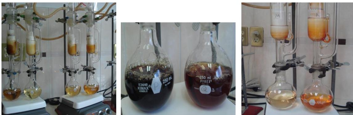
**Figura 18.** Secuencia de extracción Equipo Soxhlet.
