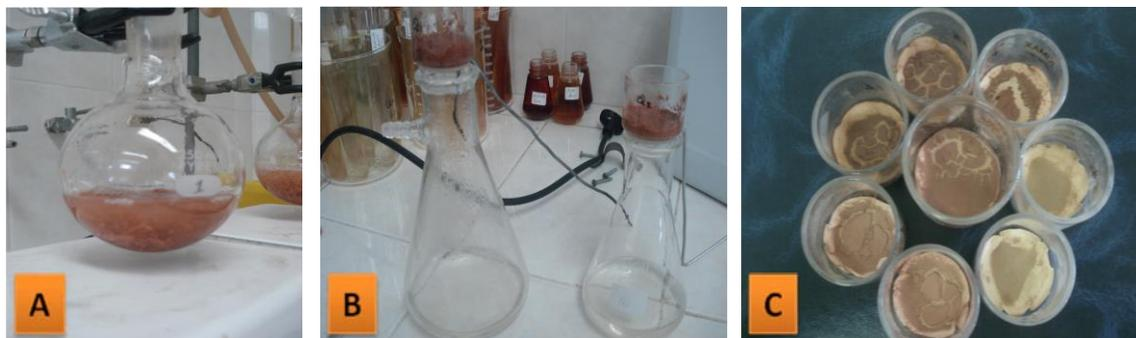
**Figura 24.** Obtención de No. Stiasny. **a)** Reacción. **b)** Filtrado. **c)** Condensado.
