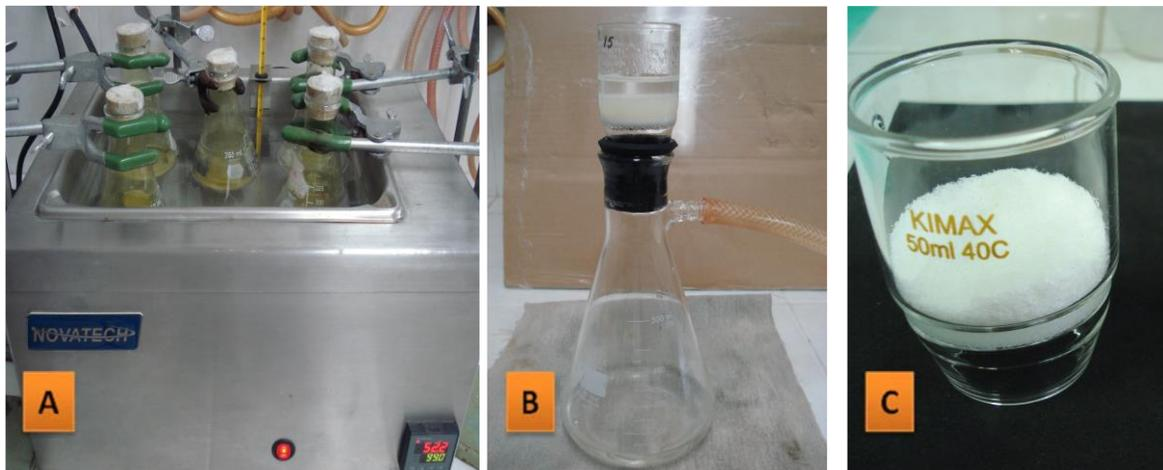
**Figura 21.** Obtención de holocelulosa. **a)** Baño María. **b)** Filtrado. **c)** Holocelulosa.
