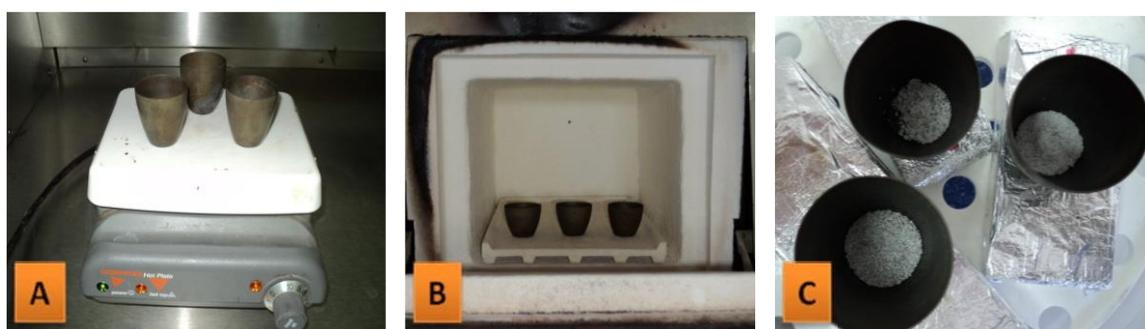
**Figura 15.** Determinación de cenizas. **a)** eliminación de orgánicos. **b)** calcinación en mufla. **c)** cenizas obtenidas.
