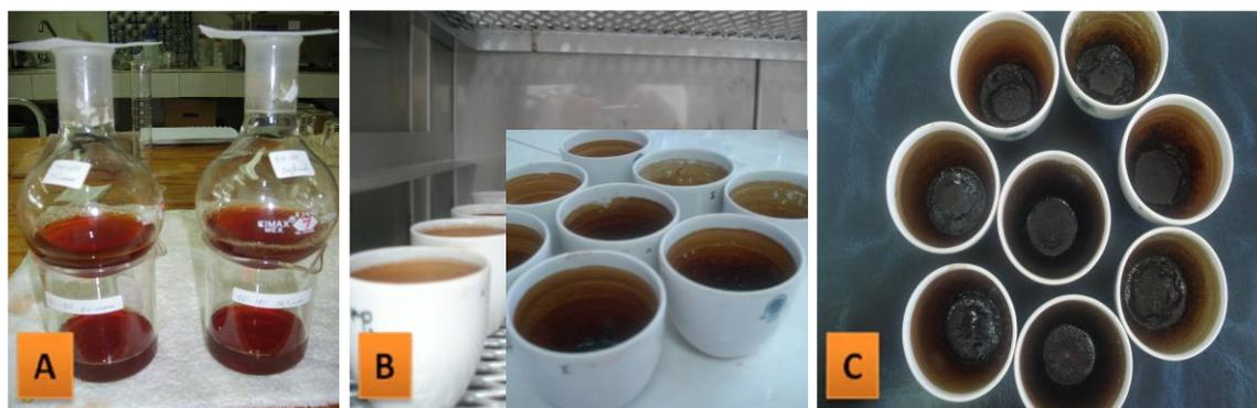
**Figura 23.** Obtención de extracto total. **a)** Extracto acuoso. **b)** Evaporación. **c)** crisol con residuos de extracto total.
