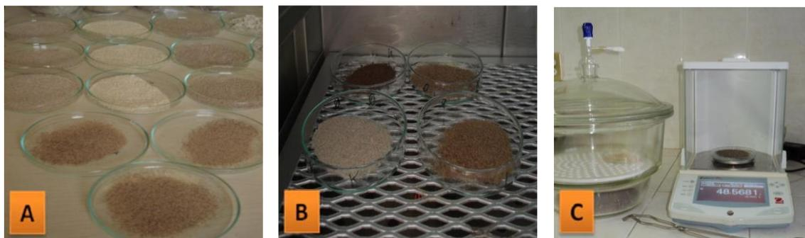
**Figura 12.** Procedimiento para determinar % de humedad. **a)** caja Petri con harina. **b)** deshidratación. **C)** desecador y balanza.
