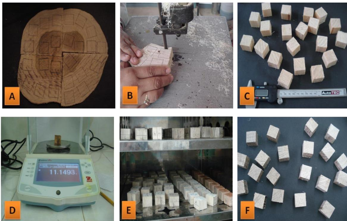
**Figura 11.** Procedimiento para determinar la densidad. **a)** Dimensionado. **b)** Aserrado. **c)** Medición. **d)** Peso. **e)** Deshidratación. **f)** Probetas a peso constante.
