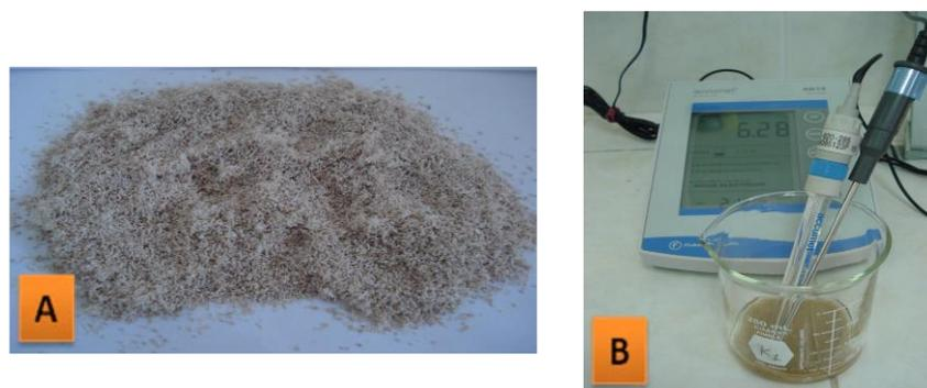
**Figura 14.** Determinación de pH. **a)** Material para lectura. **b)** Potenciómetro.
