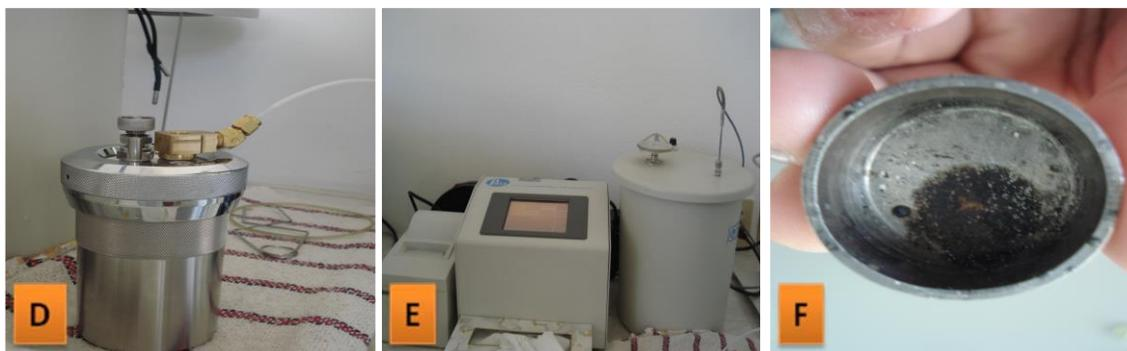
**Figura 13.** Determinación del poder calorífico. **a)** Molde para tableta. **b)** Prensa. **c)** Tabletas. **d)** Vaso de bomba. **e)** Bomba calorimétrica. **f)** Residuo de calcinación.
