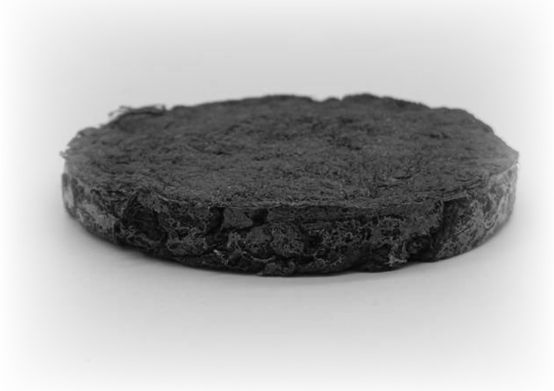
Figura 68. Material fabricado a base de goma xantana para material aglomerado en segunda etapa, sin aplicar calor durante su fabricación.
