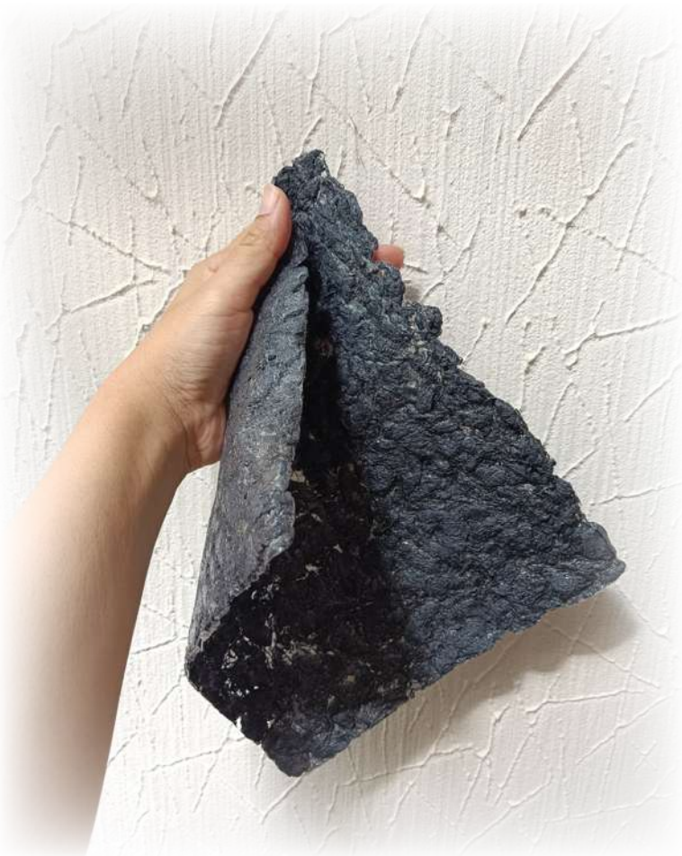
Figura 69. Material fabricado a base de goma xantana para material flexible en etapa 2.
