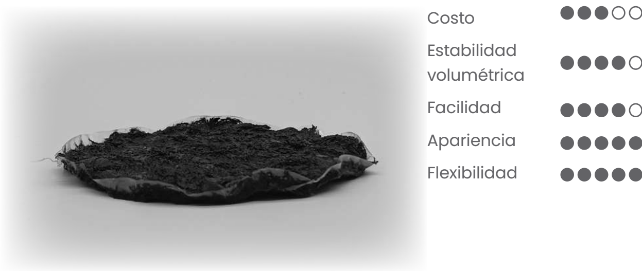
Figura 66. Material fabricado a base de grenetina para material flexible de la etapa 2.
