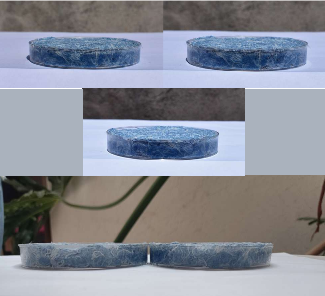
Figura 72. Cambios en la muestra expuesta al sol al ir transcurriendo el tiempo, y comparativa con muestra no expuesta al sol.
