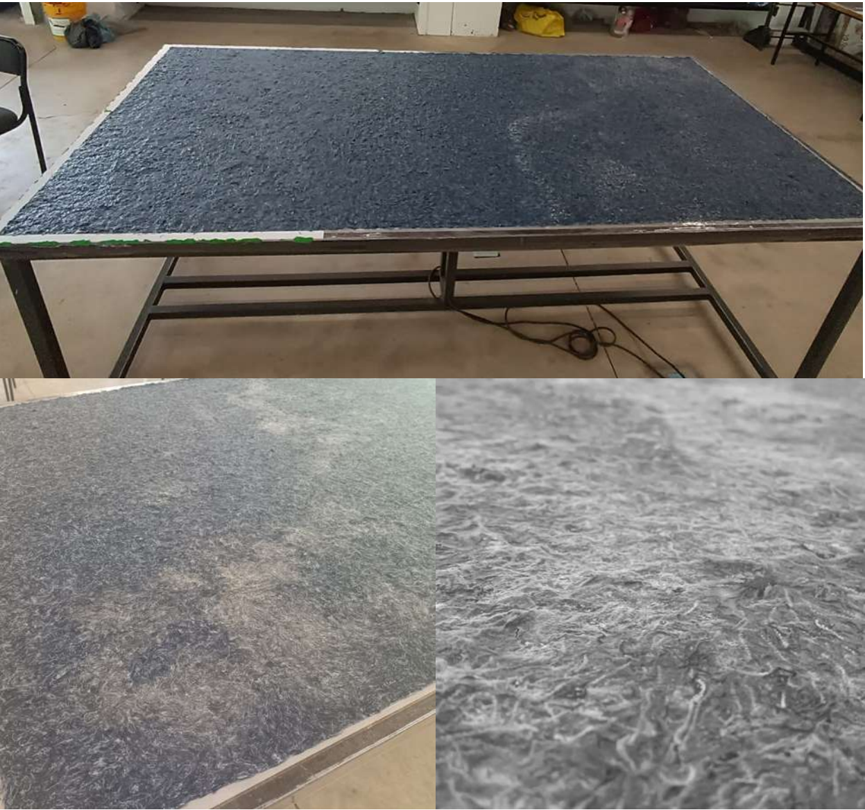
Figura 116. Presencia de moho sobre el material en los días de fabricación.
