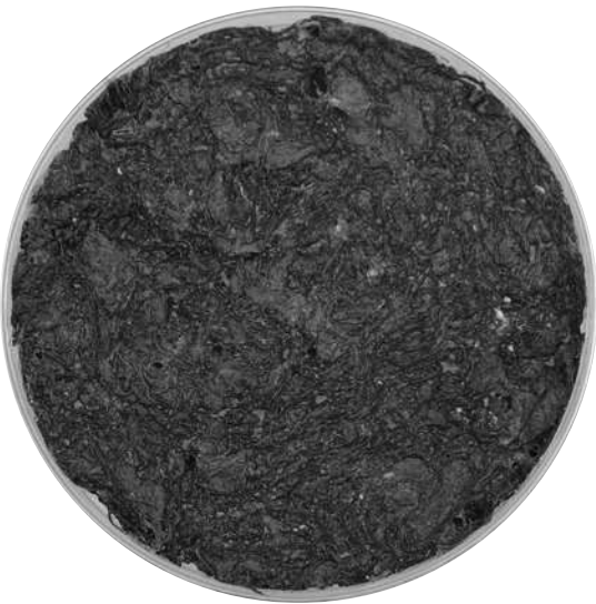
Figura 74. Material fabricado a base de goma xantana y almidón de maíz para material flexible en etapa 2.
