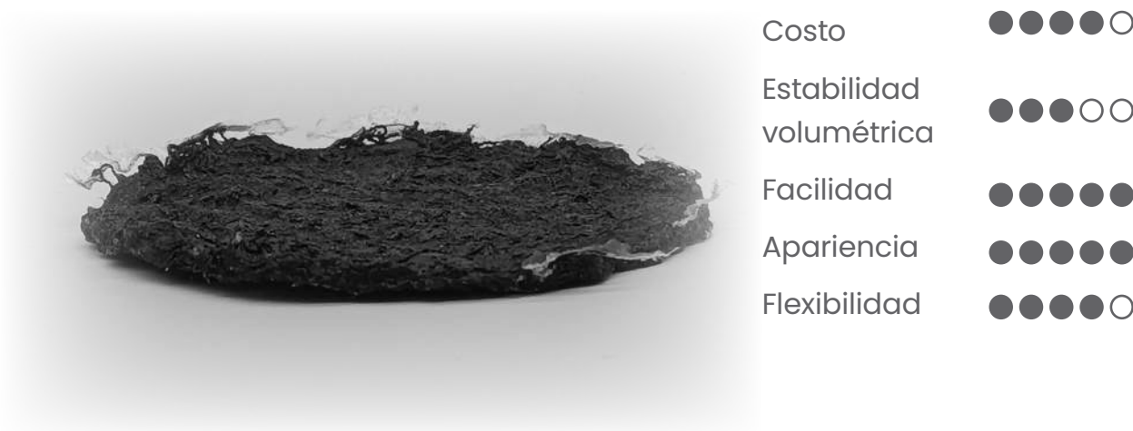
Figura 65. Material fabricado a base de almidón de maíz para material flexible de la etapa 2.
