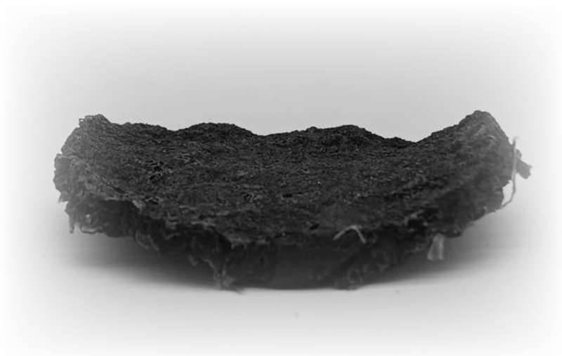
Figura 51. Material fabricado a base de grenetina para material aglomerado.
