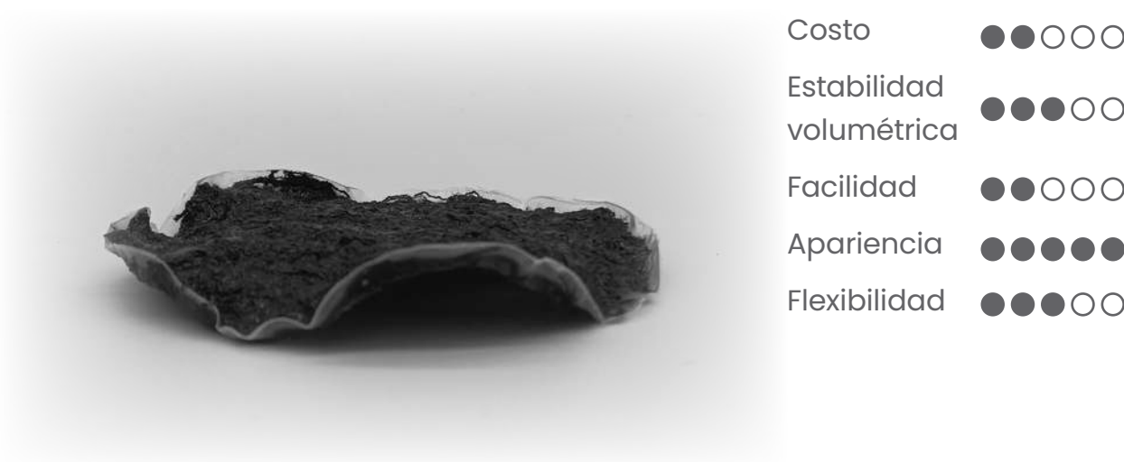
Figura 50. Material fabricado a base de grenita para material flexible.
