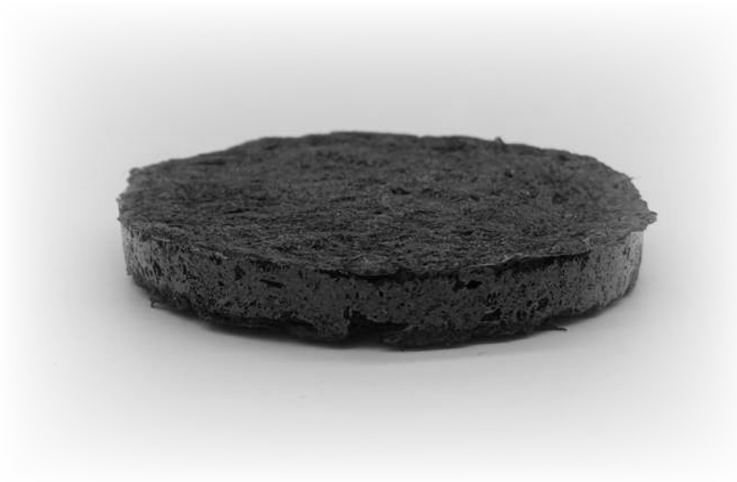
Figura 73. Material fabricado a base de goma xantana y almidón de maíz para material aglomerado en etapa 2.
