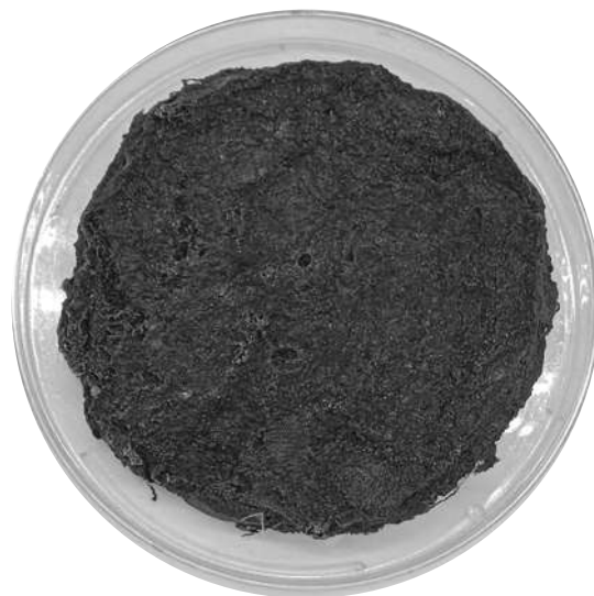
Figura 155. Fabricación de material con grenetina como aglutinante.
