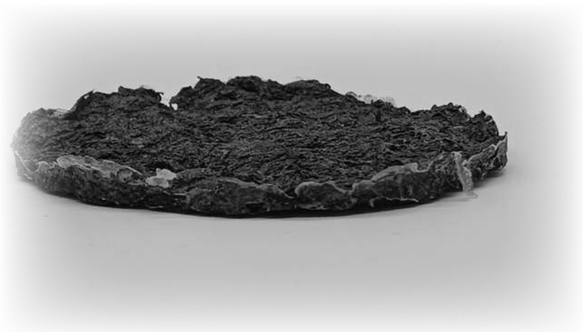
Figura 75. Material fabricado a base de agar agar y almidón de maíz para material flexible en etapa 2.
