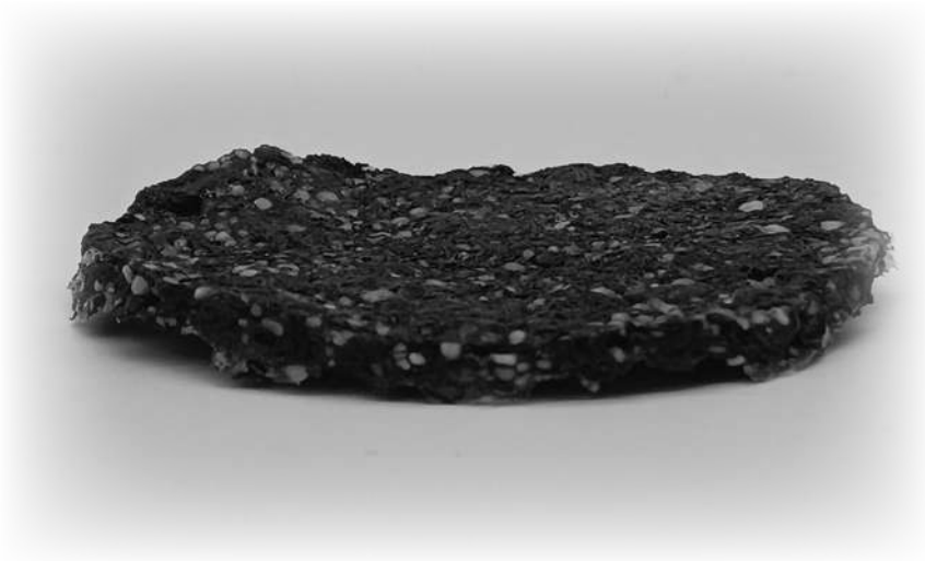
Figura 58. Material fabricado a base de tapioca para material flexible.
