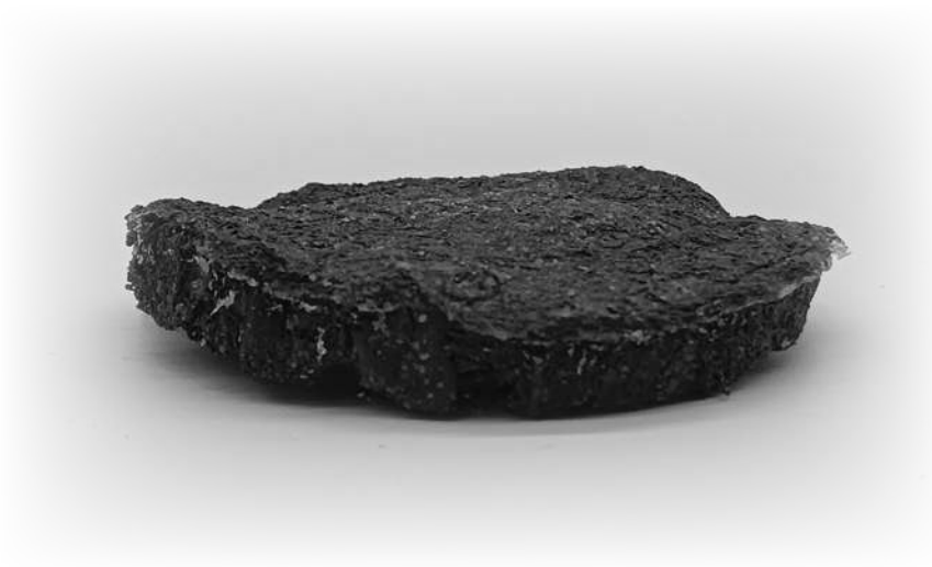
Figura 61. Material fabricado a base de harina de arroz para material aglomerado.
