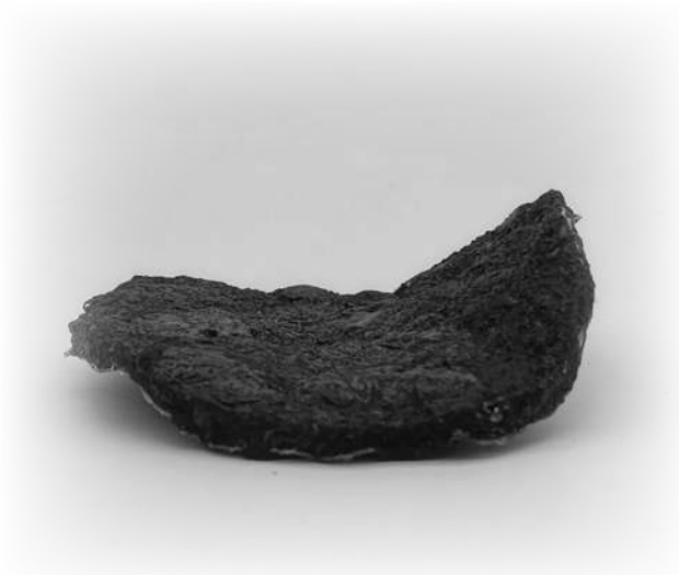
Figura 48. Material fabricado a base de almidón de maíz para material aglomerado.
