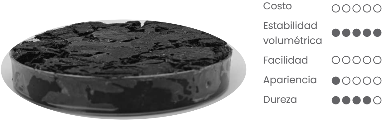
Figura 44. Material fabricado a base de resina de pino y residuo textil.
