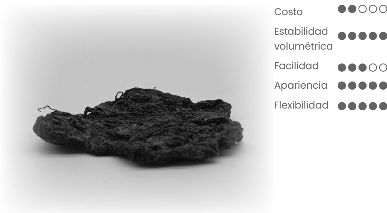
Figura 52. Material fabricado a base de agar agar para material flexible.
