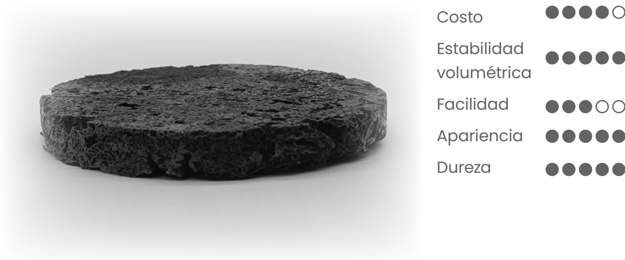
Figura 55. Material fabricado a base de goma xantana para material aglomerado.
