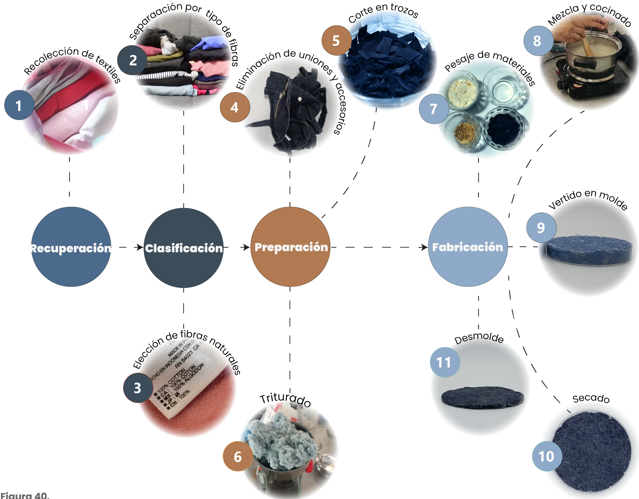
Figura 40. Proceso de fabricación del nuevo material.
