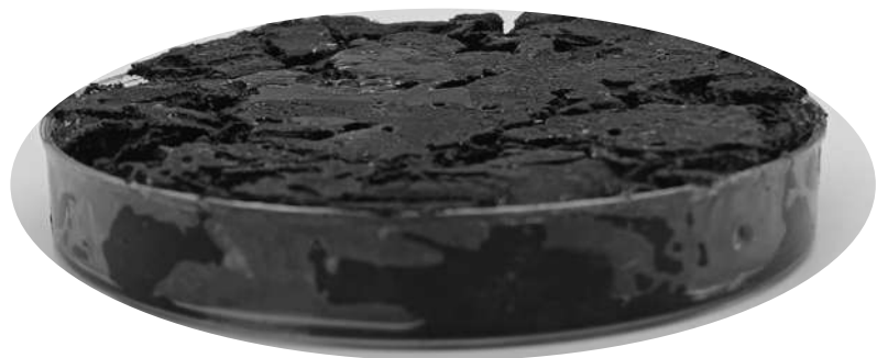
Figura 150. Fabricación de material con resina de pino como aglutinante.
