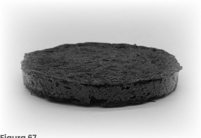
Figura 67. Material fabricado a base de rgoma xantana para material aglomerado en la etapa 2.
