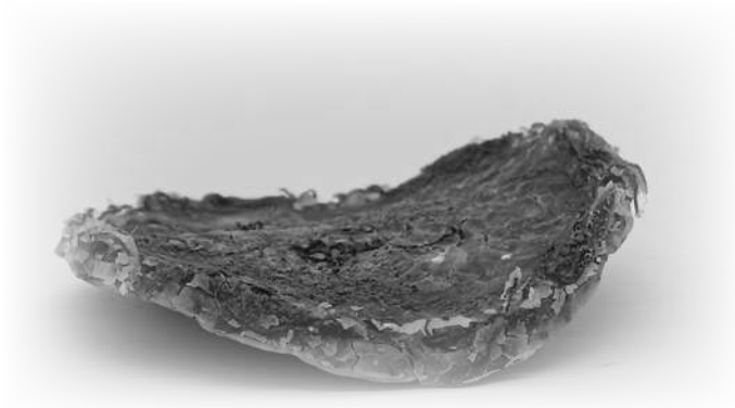
Figura 47. Material fabricado a base de almidón de maíz para material aglomerado.
