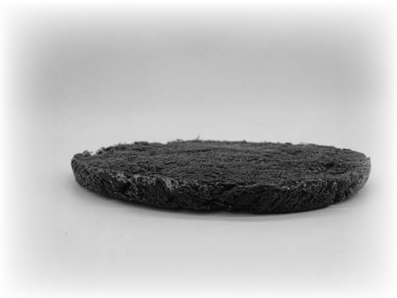
Figura 70. Material fabricado a base de resina de pino y residuo textil.
