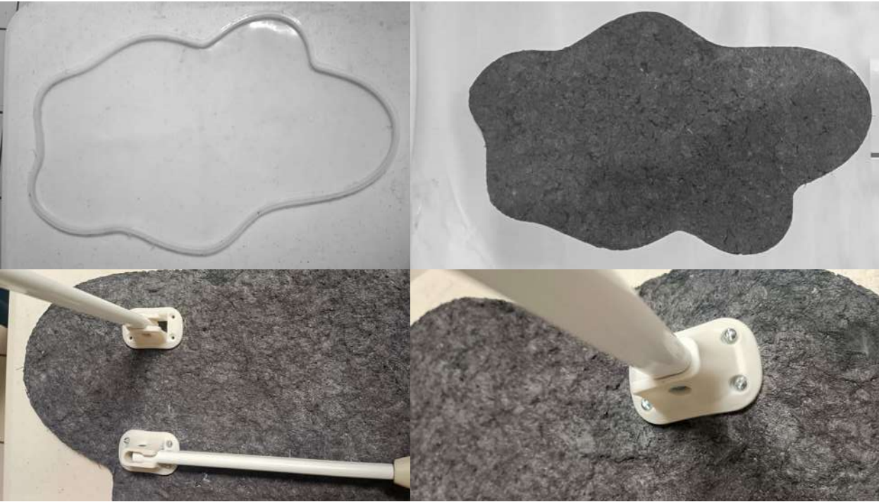
Figura 136. Fabricación de mesa pequeña fabricada con aglomerado de fécula de maíz y goma xantana.
