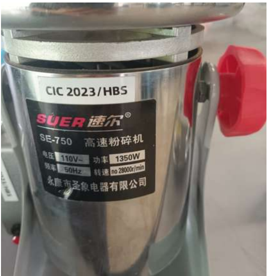
Figura 142. Molino utilizado para moler residuo textil en esta investigación.
