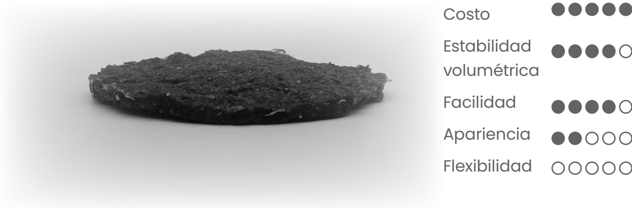
Figura 60. Material fabricado a base de harina de arroz para material flexible.
