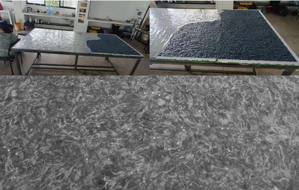
Figura 115. Primera parte de fabricación del material para panel lumínico.
