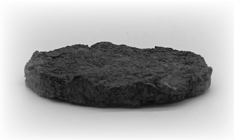
Figura 54. Material fabricado a base de agar agar para material aglomerado.
