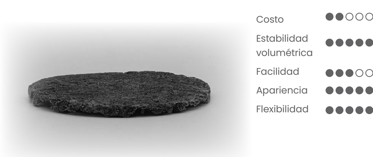
Figura 53. Material fabricado a base de agar agar para material flexible.
