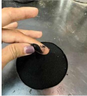
*Figura 11 Caucho molido tipo polvo retenido en la malla 60, fuente propia*
