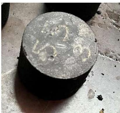
*Figura 37 Probeta con el 5.5% de asfalto para el 3% de PET*
