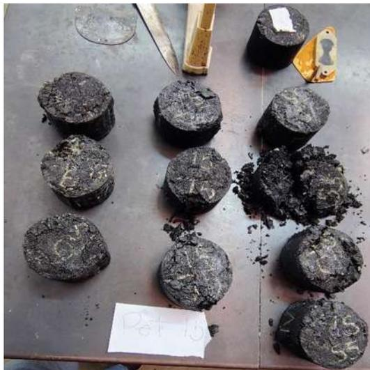
Figura 39 Probetas con el 1.5% de PET probadas en método Marshall
