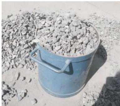
*Figura 6 Agregado grueso grava triturada, fuente propia*
