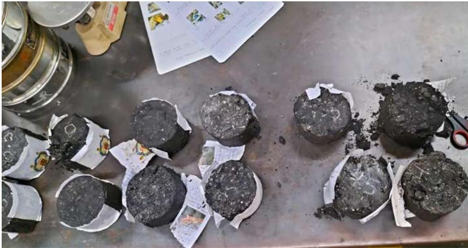
*Figura 40 Probetas con adición de polvo de caucho, probadas método Marshall*
