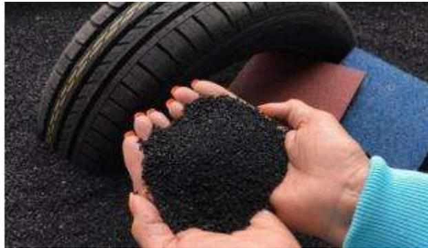
Figura 4 caucho procesado y molido (Reciclaje de Neumáticos, 2019)
