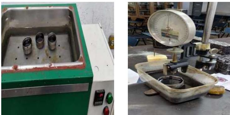
Figura 13 Prueba de penetración, fuente propia
