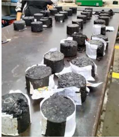
*Figura 41 probetas con adición de fibras de PET probadas en método Marshall*
