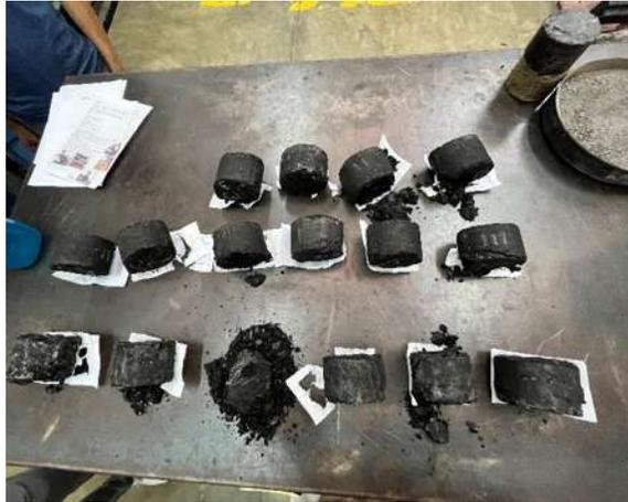
Figura 38 Probetas convencionales, Método Marshall
