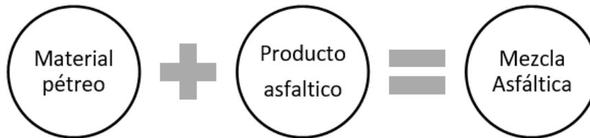
Figura 7 Mezcla asfáltica
