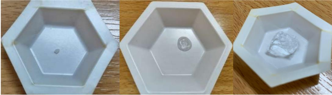
Figura 26. Experimento para determinar la cantidad de agua que puede absorber el polímero PAAM.
