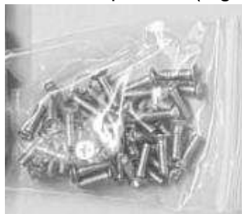
Figura 22.- Tornillos hexagonales M3x10mm. Fuente: Elaboración propia.
