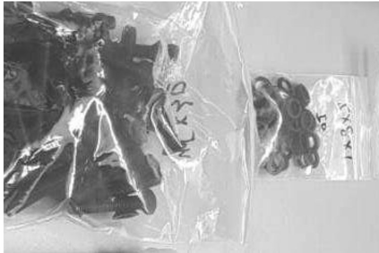
Figura 24.- Tornillos y tuercas M5x30mm con arandelas. Fuente: Elaboración propia.
