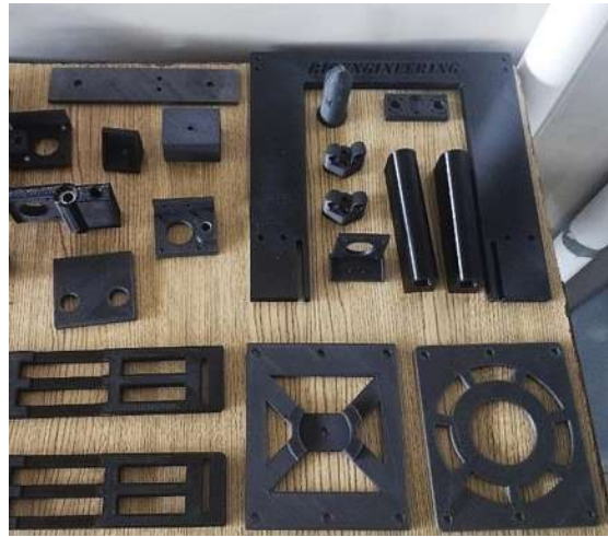
Figura 36.- Algunas piezas impresas para la bioimpresora. Fuente: Elaboración propia.
