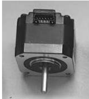
Figura 21.- Ficha técnica y medidas del Motor de paso Nema 17 de 42x47mm. Fuente: Elaboración propia.
