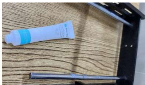
Figura 37.- Aplicación de lubricante a las barras de acero inoxidable. Fuente: Elaboración propia.
