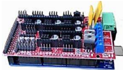
Figura 44.- Montaje de la tarjeta Shield Ramps 1.4 sobre la placa Arduino Mega 2560. Fuente: Elaboración propia
