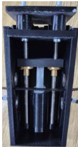
Figura 41.- Mecanismo para la extrusión de la biotinta. Fuente: Elaboración propia.
